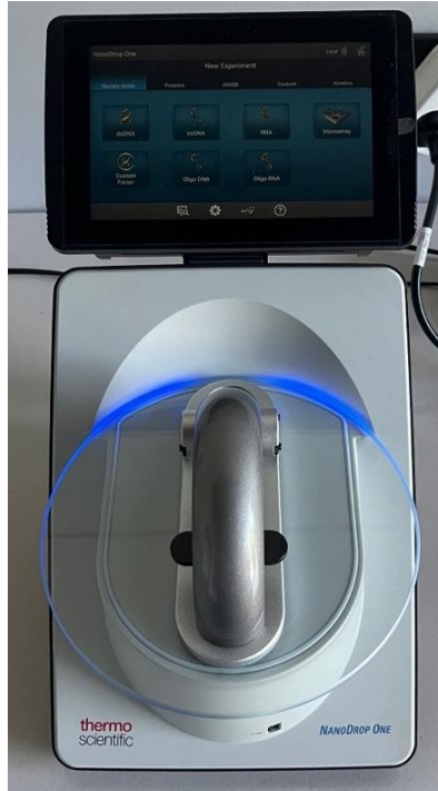
Şekil 3.1: Nanodrop One ölçüm cihazı (Thermo Scientific, ABD).
