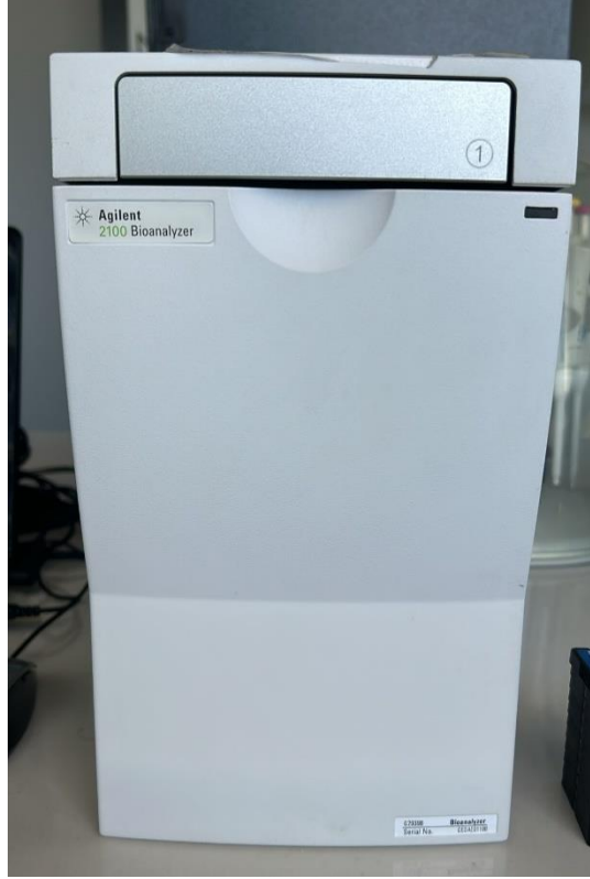
Şekil 3.3: Bioanalyzer 2100 otomatize elektoroforez cihazı (Agilent, ABD).
