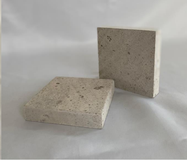
Şekil 4.13. Açık Bej (Gesi) Andeziti
