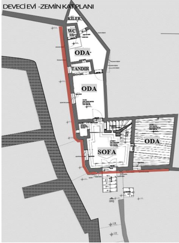
Şekil 4.98. Deveci Evi Zemin Kat Planı
