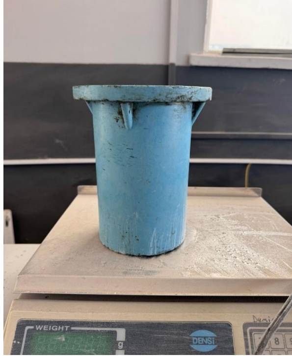
Şekil 3.8. Silindir numune kalıbı
