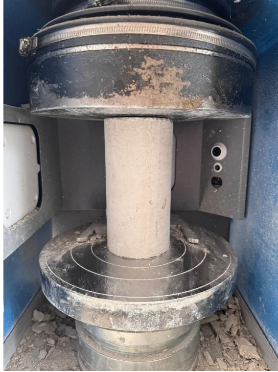
Şekil 3.14. Silindir numunenin basınç dayanımı deneyi
