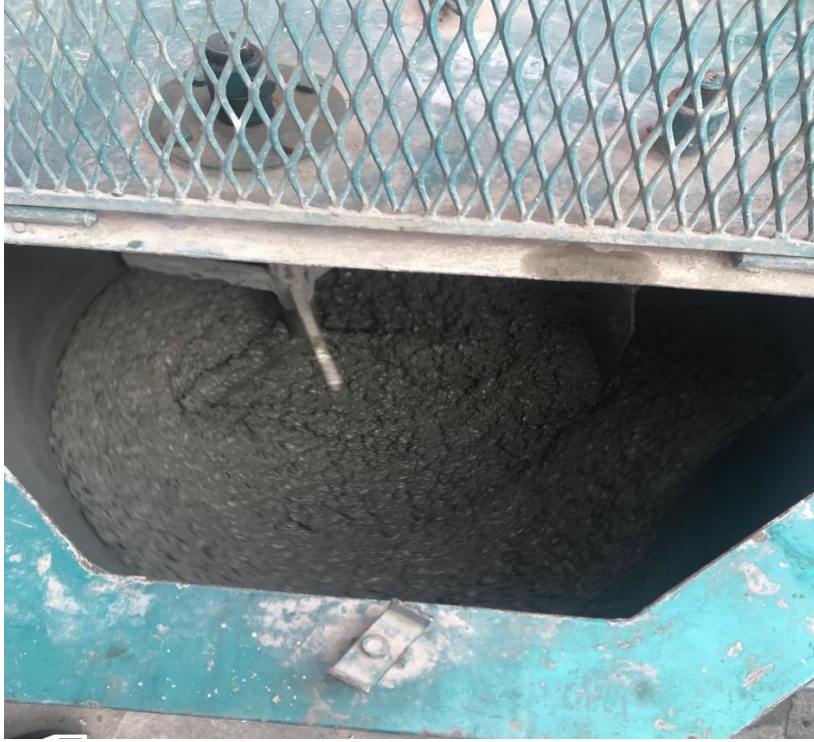
Şekil 3.6. Hafif beton numunelerinin hazırlanması
