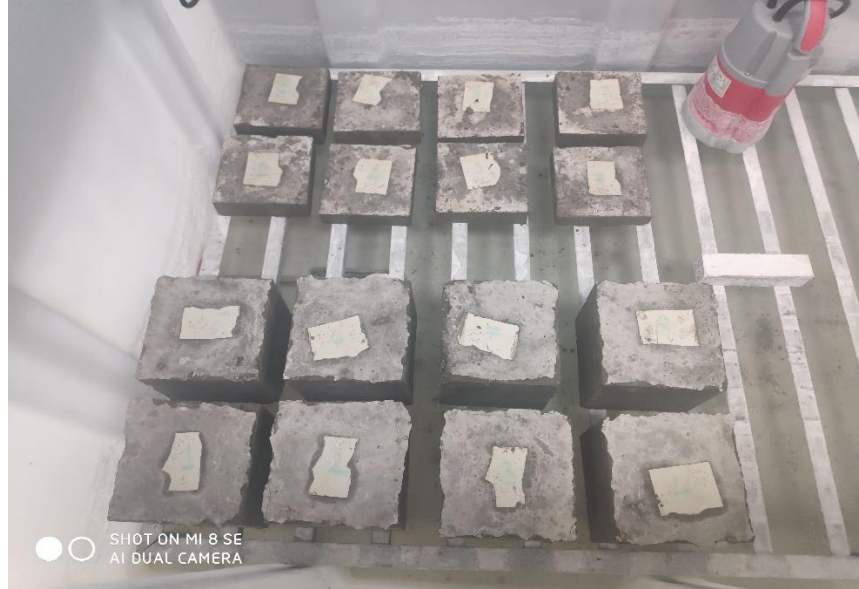
Şekil 3.11. Hafif beton numunelerinin kürlenmesi
