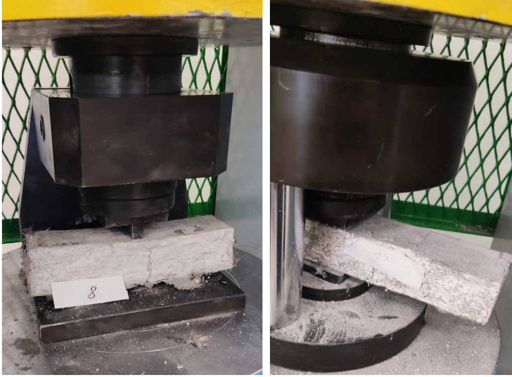
Şekil 4. 5. Deney numuneleri eğilme ve basınç testleri.
