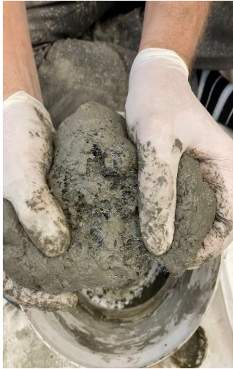
Şekil 4. 4. İşlenebilir ECC karışımı ve ECC'de mermerimsi yüzey.
