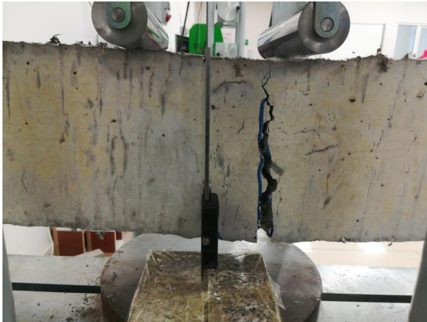
Şekil 4. 10. 100x180x1200 mm ebatlarındaki kirişe uygulanan eğilme deneyi.
