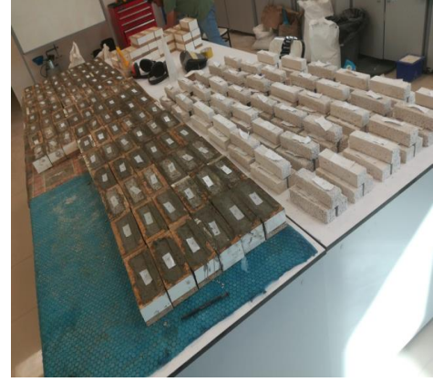
Şekil 3. 10. 40×40×160 mm boyutlarında hazırlanmış 49 adet farklı numune.
