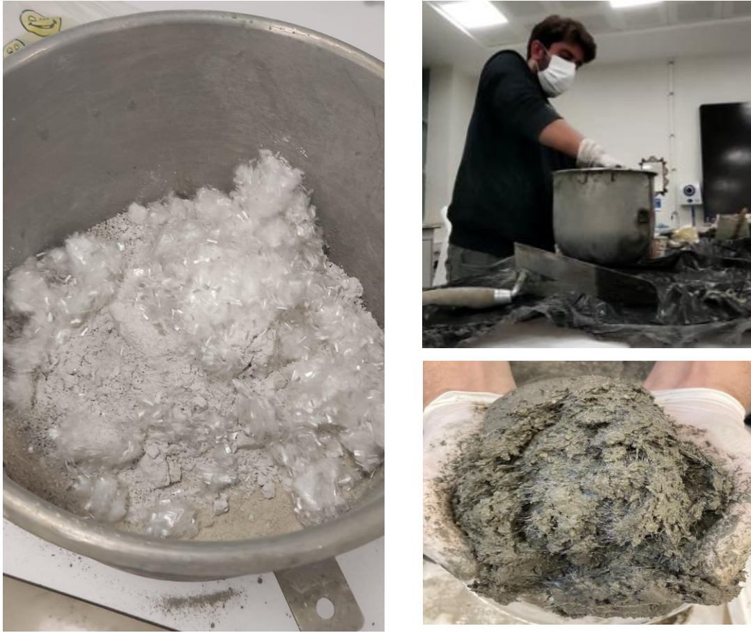
Şekil 3. 9. 40x40x160 mm numunelerin hazırlanması.
