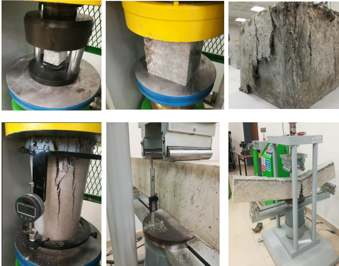
Şekil 3. 12. Silindir numunelerin gerilme-şekil değiştirme ilişkisi ve kiriş numunelerin yük-deformasyon davranışının test edilmesi.
