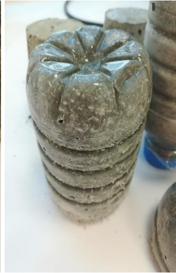
Şekil 4. 4. İşlenebilir ECC karışımı ve ECC'de mermerimsi yüzey.
