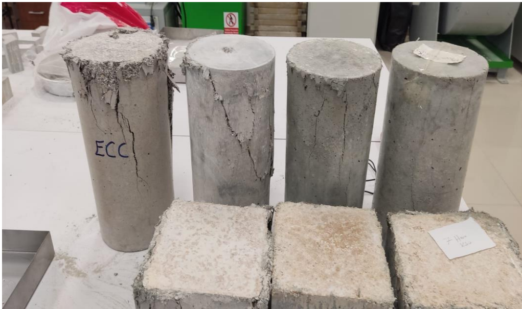
Şekil 4. 9. ECC ve geleneksel beton silindir numune çatlak gelişimi.
