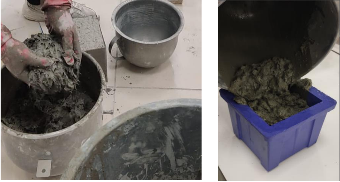
Şekil 4. 2. ECC karışımında işlenebilirlik ve kalıba yerleştirme.
