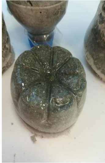
Şekil 4. 4. İşlenebilir ECC karışımı ve ECC'de mermerimsi yüzey.
