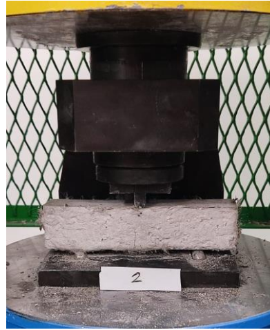
Şekil 3. 11. 40×40×160 mm boyutlarındaki kiriş numunesinin eğilme testleri sırasında laboratuvar ortamındaki uygulama görüntüsü.
