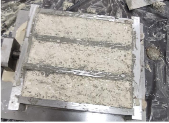
Şekil 3. 10. 40×40×160 mm boyutlarında hazırlanmış 49 adet farklı numune.
