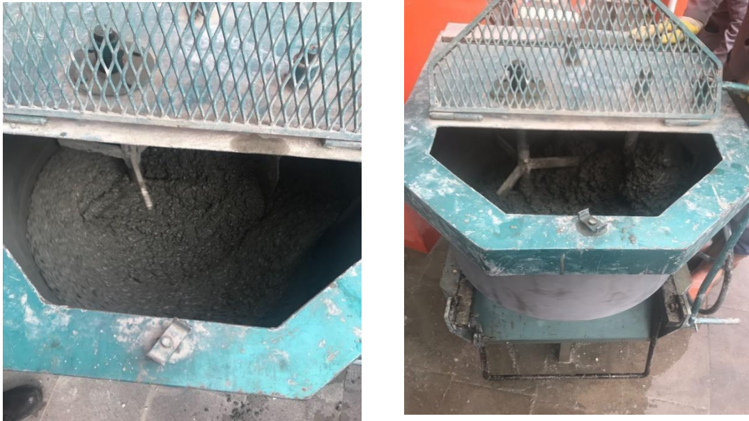
Şekil 3.6. Hafif beton hamuru
