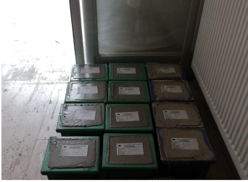
Şekil 3.7. Numunelerin kalıp içerisinde bekletilmesi
