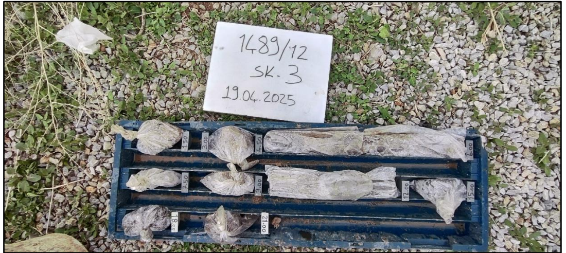
Şekil 4.7. SPT arazide numune alımı
