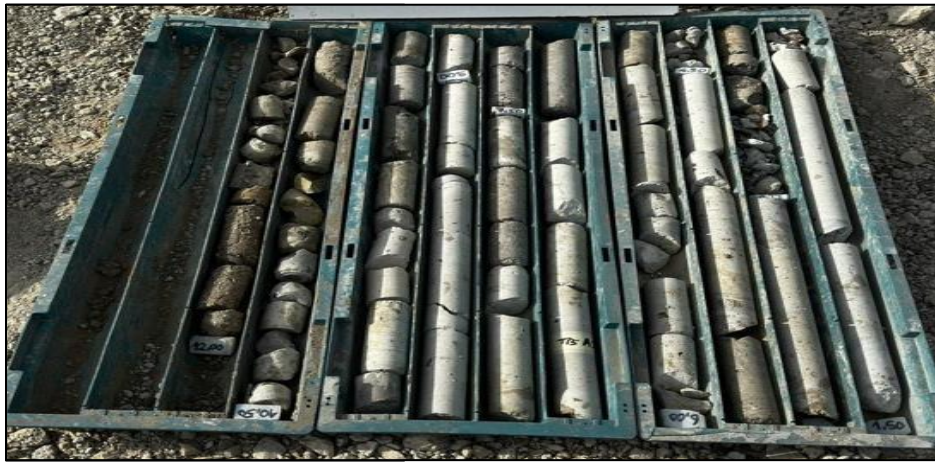
Şekil 3.13. Jet grout kolonu kafasından karot numunesi alımı
