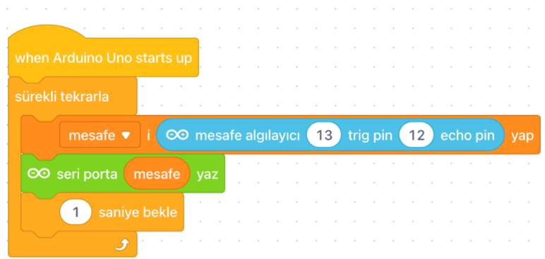
Şekil 3.10. mBlock Programında Ultrasonik Mesafe Sensörü Kodlama Aşaması
