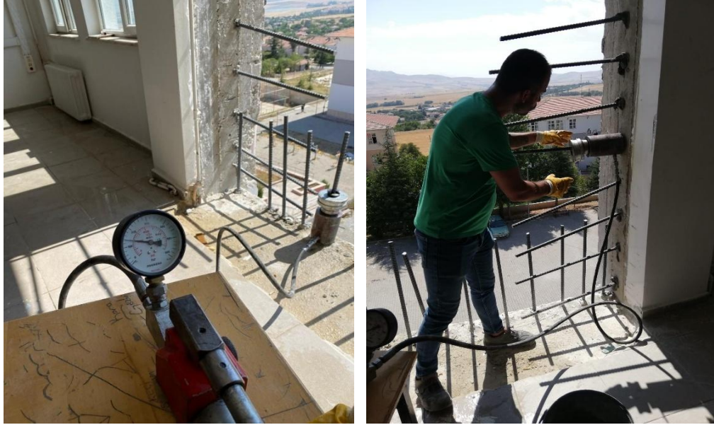
Şekil 4.111. Ankraj çekme deneyleri yapılması
