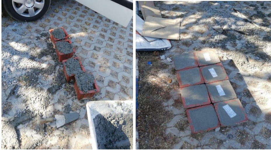
Şekil 4.117. Dökülen beton numunelerinin alınması
