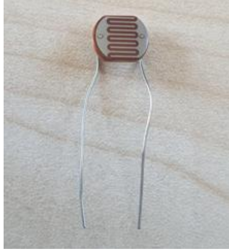
Şekil 3.16. LDR Sensör (Işığa Bağımlı Direnç)
