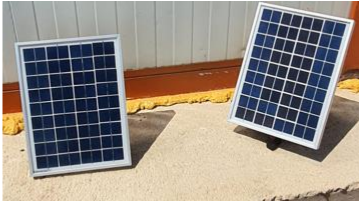
Şekil 3.18. Sabit ve Hareketli Sistemin Öğleden Sonraki Bir Konumu
