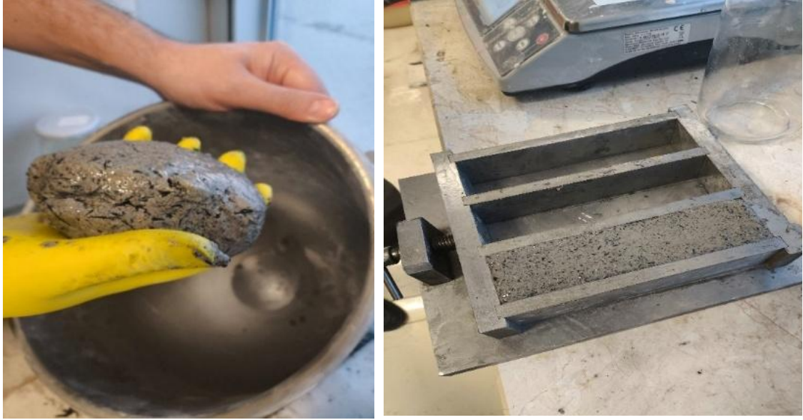
Şekil 3.11. Karışım-4 (K-4) numunesi ve kalıplanmış hali
