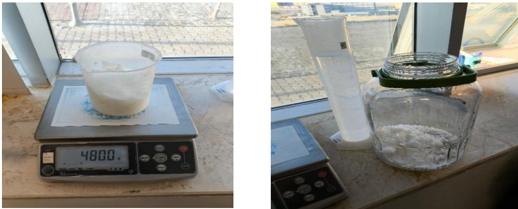
Şekil 3.9. Alkali aktivatörünün hazırlanması
