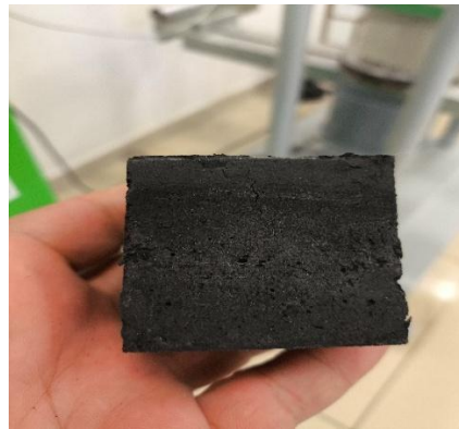
Şekil 3.24. K-21 50x50x50 mm küp numune basınç dayanım testi
