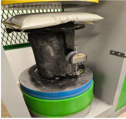
Şekil 3.27. Gerilme – şekil deęiřtirme testi
