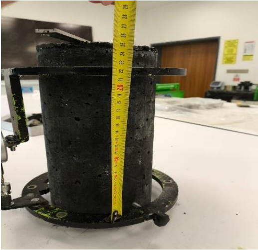
Şekil 3.27. Gerilme – şekil deęiřtirme testi
