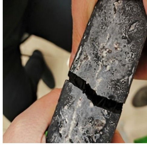
Şekil 3.25. K-21 40x40x160 mm numune eğilme dayanımı testi
