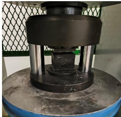
Şekil 3.24. K-21 50x50x50 mm küp numune basınç dayanım testi
