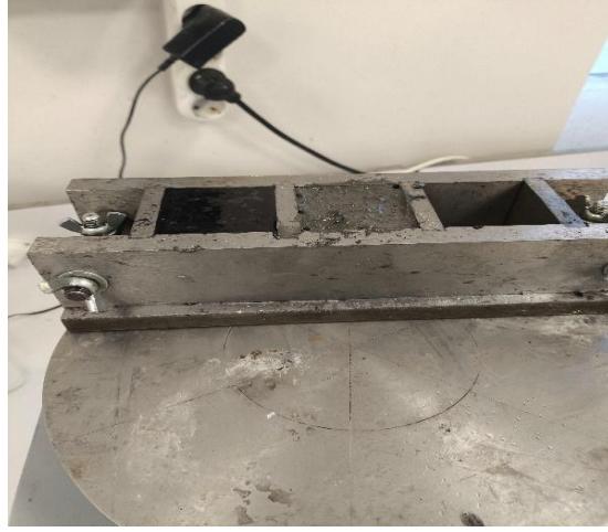
Şekil 3.18. K-17 ve K-18 karışımlarının kalıplara dökülmesi
