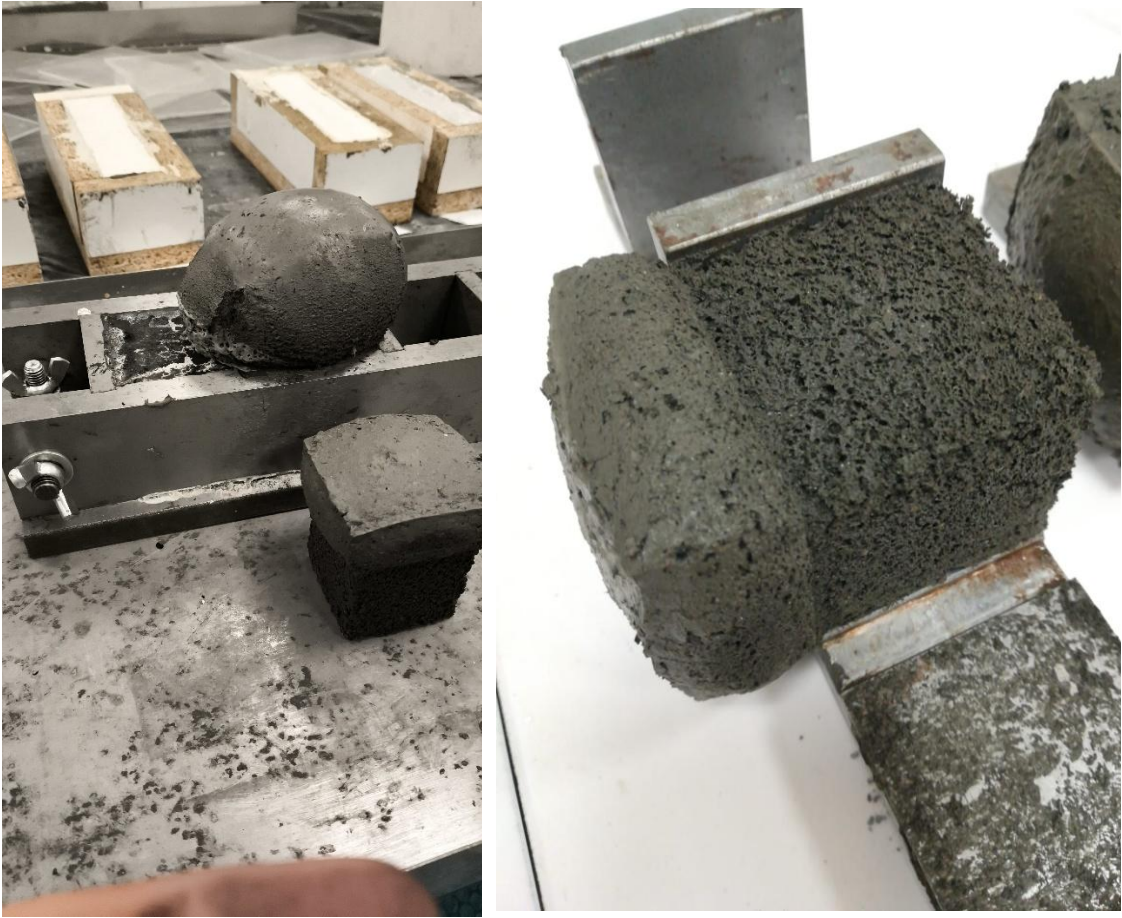
Şekil 4.2. K-18 karışımının hacimsel artışı
