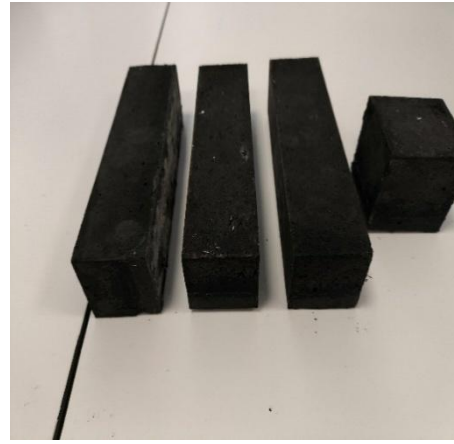
Şekil 3.22. K-21 numuneleri ve 7 günlük ısı kürü sonrası durumları
