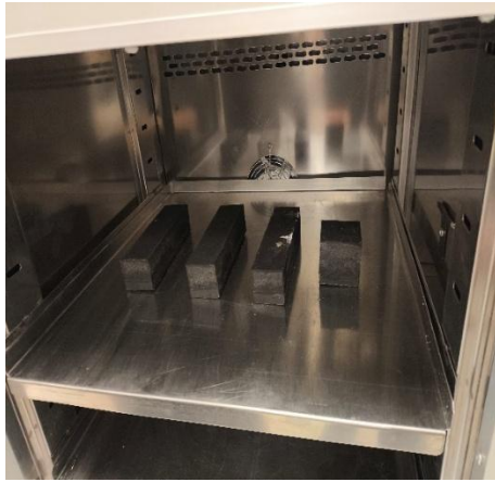
Şekil 3.22. K-21 numuneleri ve 7 günlük ısı kürü sonrası durumları
