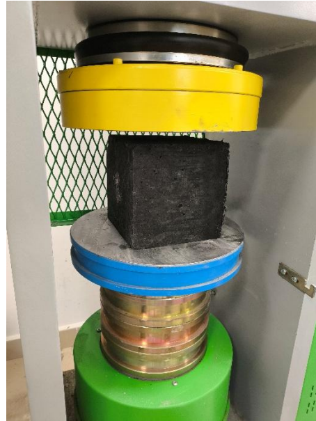
Şekil 3.26. K-21 150x150x150 mm küp numune basınç dayanım testi
