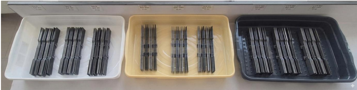
Şekil 3.3. HCl, NaOH ve %3.5 NaCl çözeltilerinin hazırlandığı deney kapları / daldırma düzeneği
