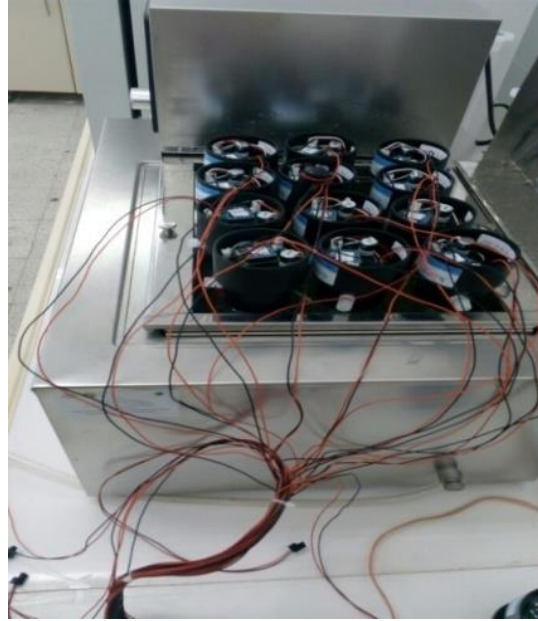
Şekil 3.1. ANKOM RF gaz üretim sisteminde şişelerin modül başlıkları
