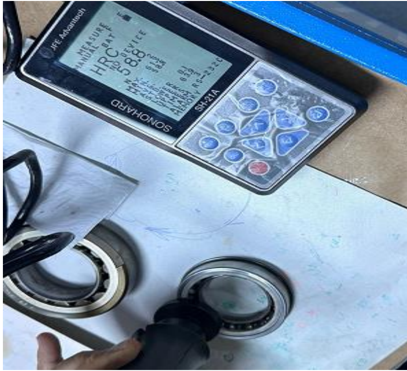
Şekil 3.10. Motor bearingi sertlik değeri
