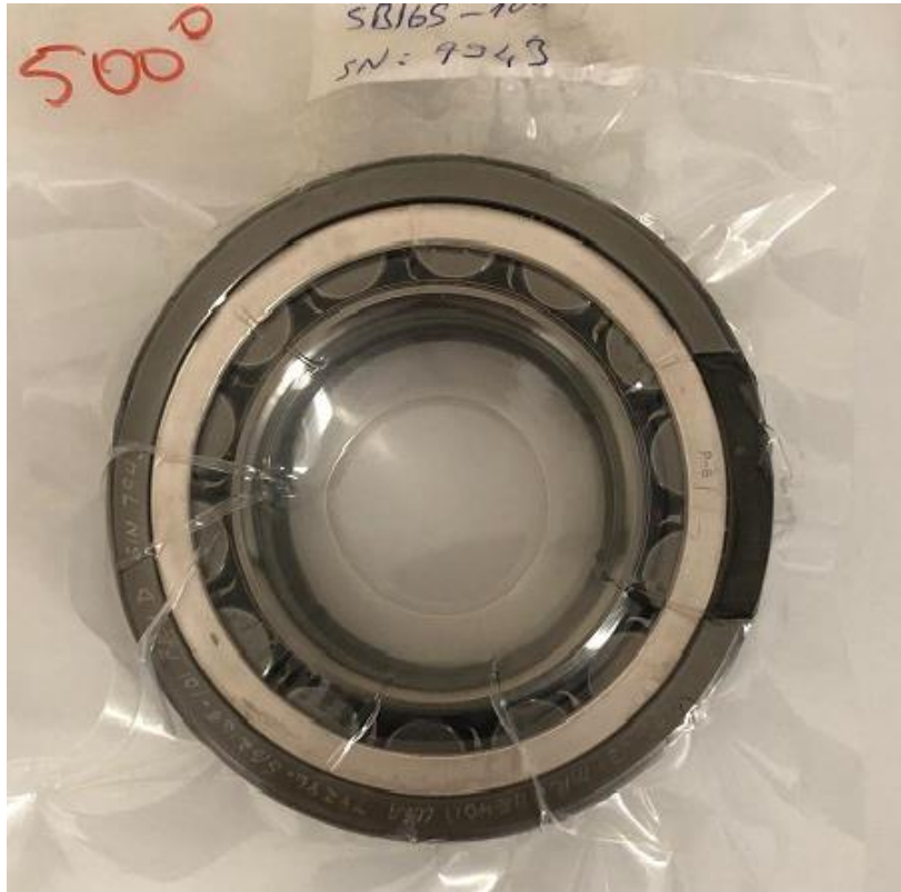
Şekil 4.6. 500°C’de fırınlanmış input modül bearingi
