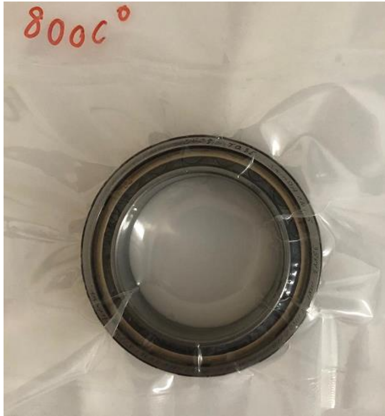
Şekil 4.2. 800°C'de fırınlanmış motor bearingi
