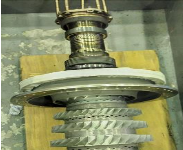
Şekil 3.3. Motor rulmanının monte edildiği kompresör kısmı
