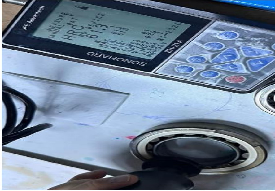
Şekil 3.9. İnut modül bearingi sertlik değeri
