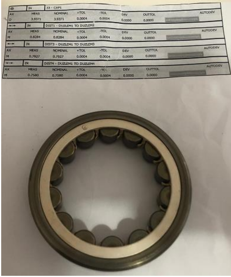
Şekil 3.14. İnut modül bearingi dış kafes çap ölçümü
