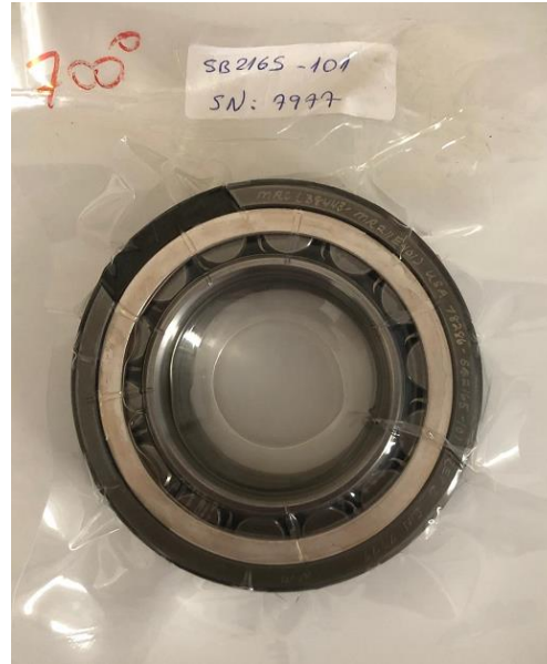
Şekil 4.4. 700°C'de fırınlanmış input modül bearingi
