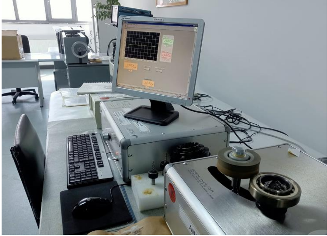
Şekil 3.11. Input modül bearingi titreşim testi
