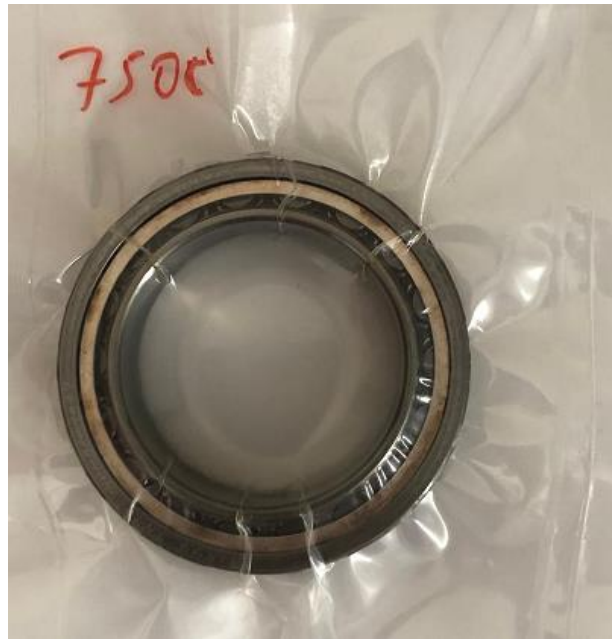
Şekil 4.3. 750°C’de fırınlanmış motor bearingi
