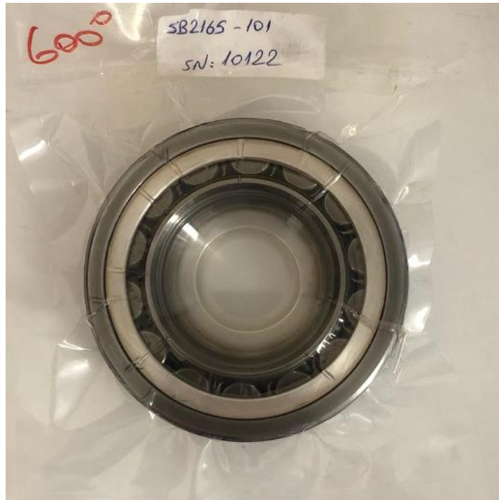
Şekil 4.5. 600°C’de fırınlanmış input modül bearingi
