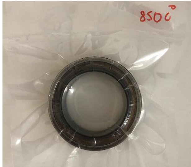
Şekil 4.1. 850°C'de fırınlanmış motor bearingi
