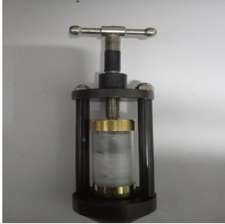
Şekil 3.51. Kovan kıvrırma presinde başlık montajı
