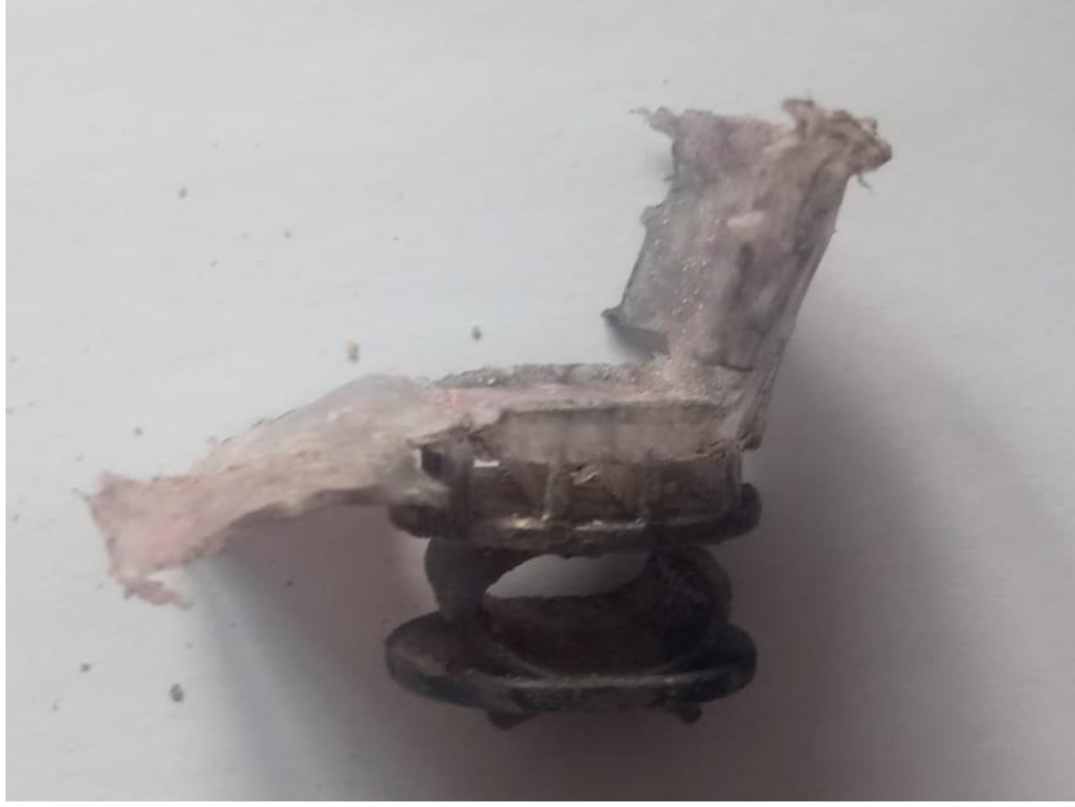
Şekil 3.42. F003 numaralı fişeginin atımı sonrası bior tapanın durumu
