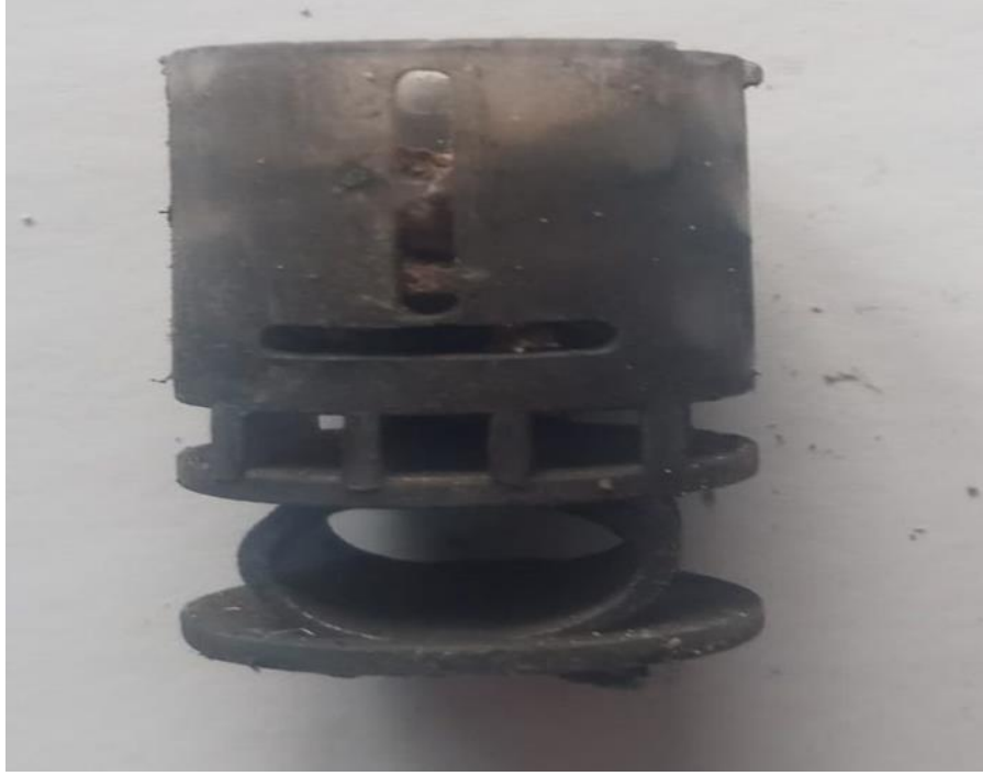
Şekil 3.41. F001 numaralı fişeğin atımı sonrasında bior tapanın durumu
