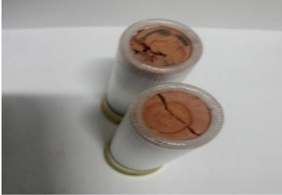
Şekil 3.58. Montaj sırasında hasar gören delici başlıklar
