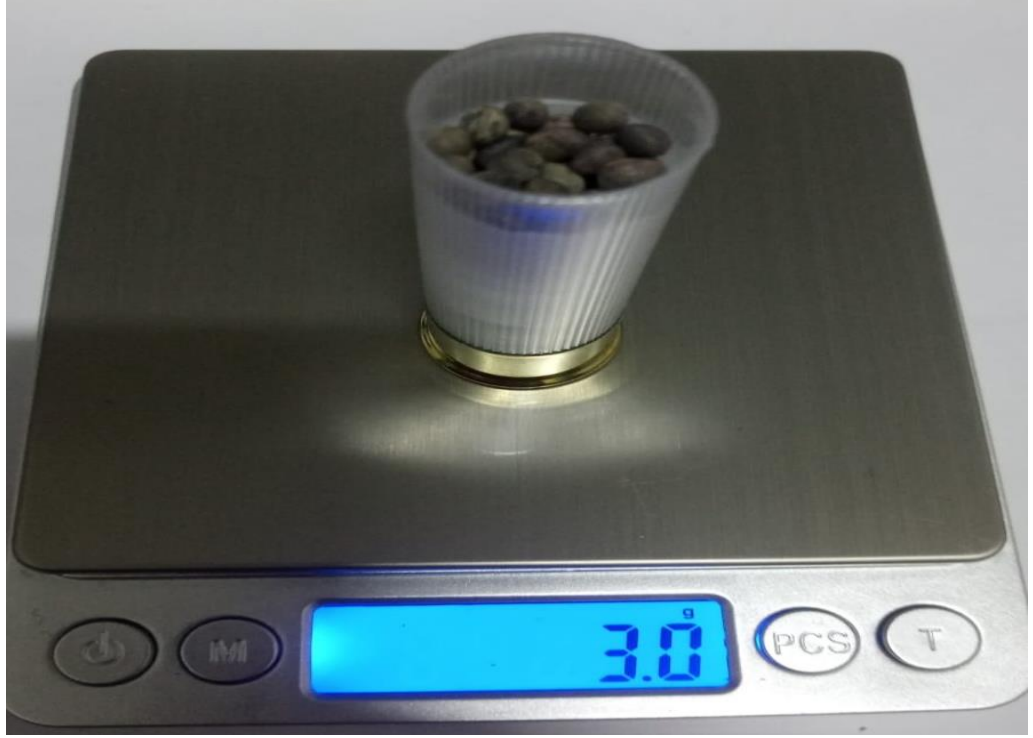
Şekil 3.50. Doldurulabilir maksimum tohum ağırlığı
