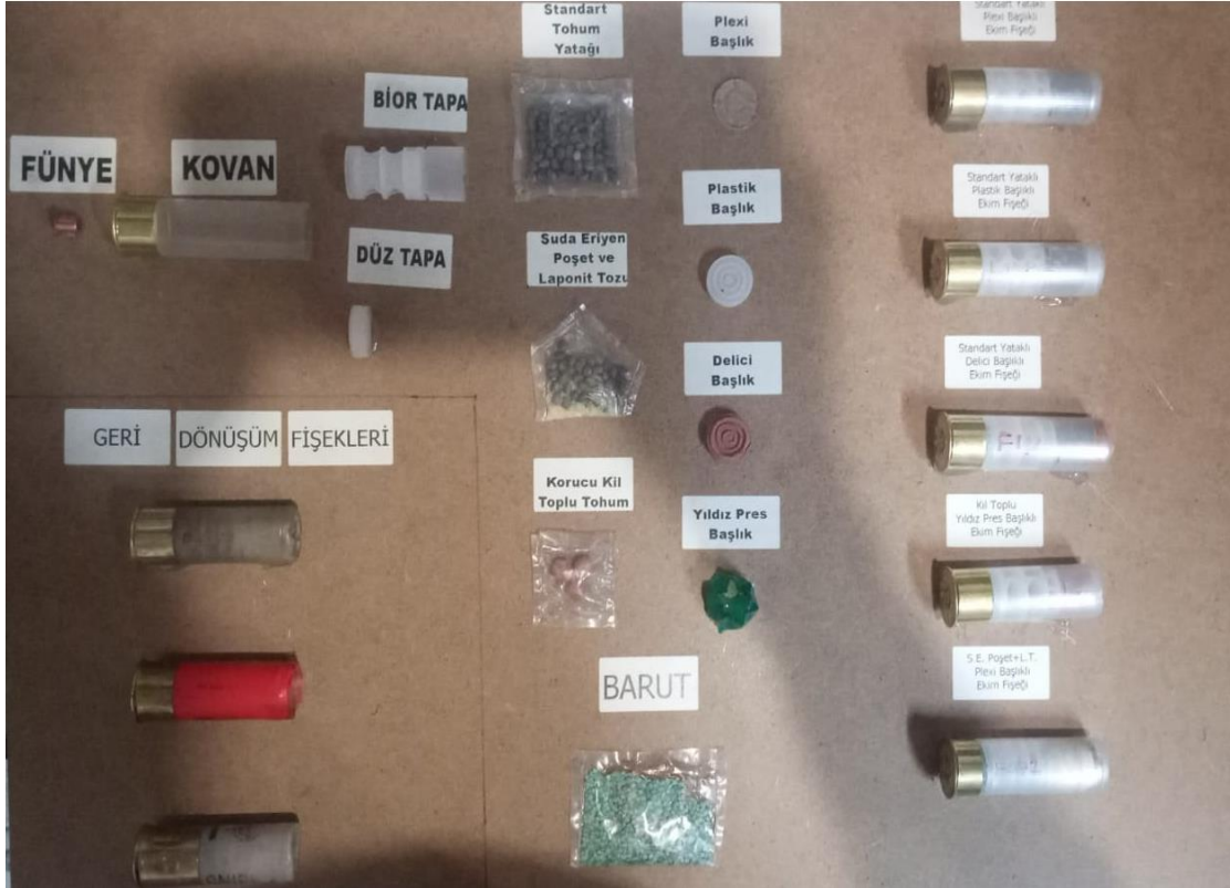
Şekil 3.89. Bir tohum ekim fişegini oluşturabilecek yapıların şeması
