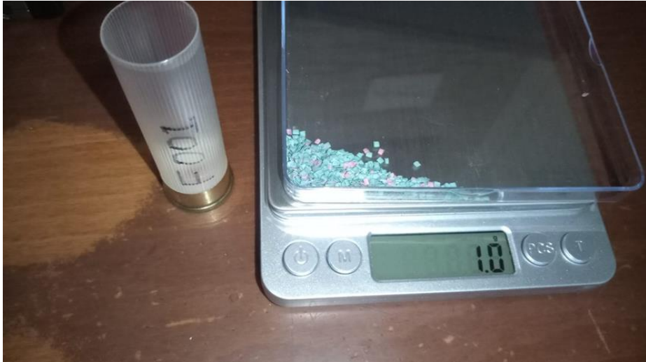
Şekil 3.31. F001 numaralı fişeğe doldurulan barutun miktarının belirlenmesi
