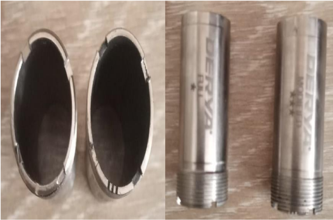
Şekil 3.11. Mobil şok çeşitlerinin sökülmüş halde üstten ve yandan görünümü
