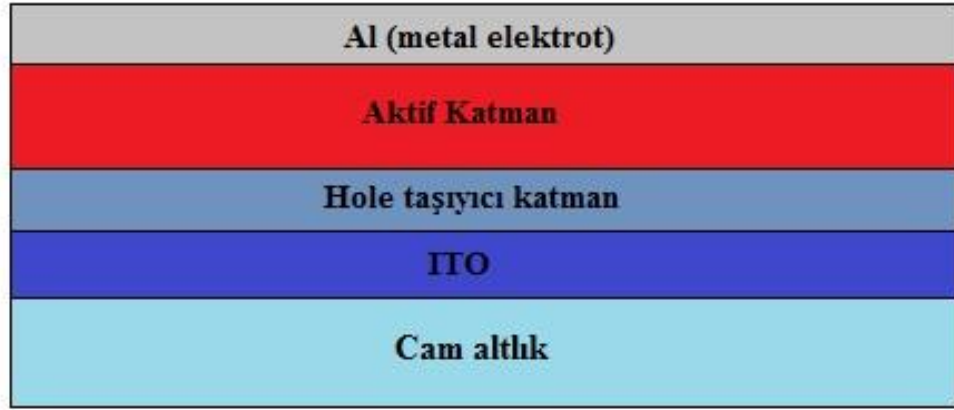
Şekil 2.6 Tipik bir polimer güneş hücresinin şematik gösterimi verilmiştir.
