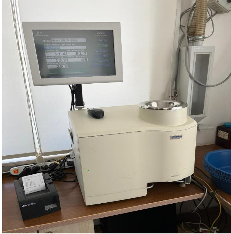
Şekil 3.5. NIT aleti (IM Perten 9500 hızlı protein ve hektolitre ölçüm aleti) (Orijinal, Ülkü YILDIZ KIZIL)
