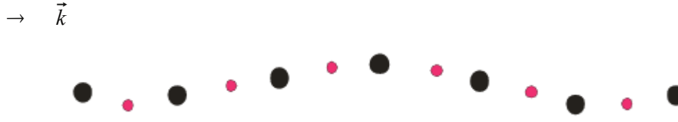
Şekil 2.23. İki atomlu zincir için enine akustik mod.
