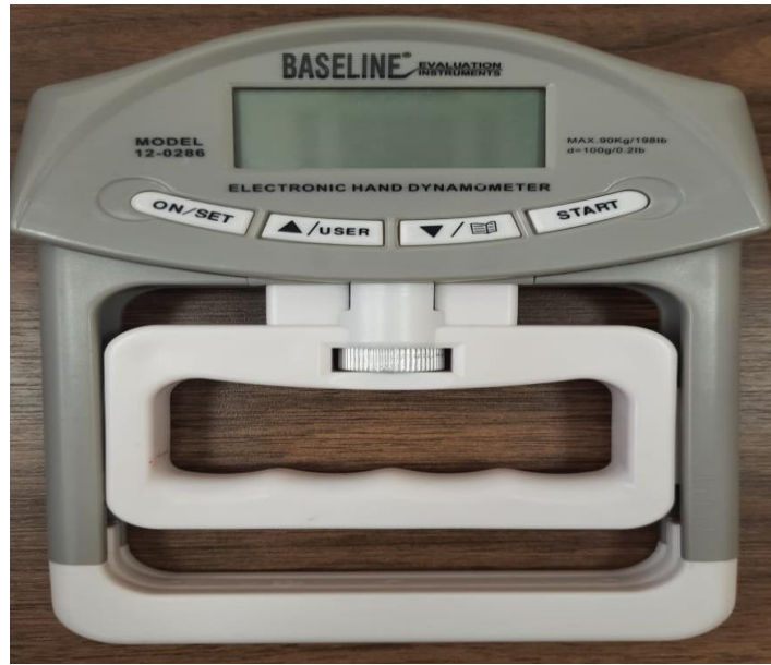
Şekil 3.1: Değerlendirmede kullanılan Baseline Evaluation Instruments Electronic Hand Dynamometer - Max 90 kg (Model 12 - 0286) marka el dinamometresi.
