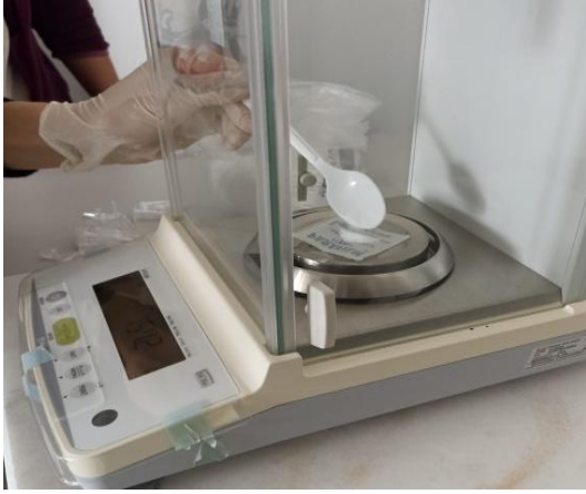
Şekil 3. 3. Borik asitin hassas terazide tartılması (Ave B).
