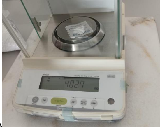
Şekil 3. 3. Borik asitin hassas terazide tartılması (Ave B).
