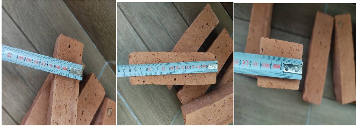
Şekil 3.6. Numunelerin en, boy ve yükseklik ölçümleri
