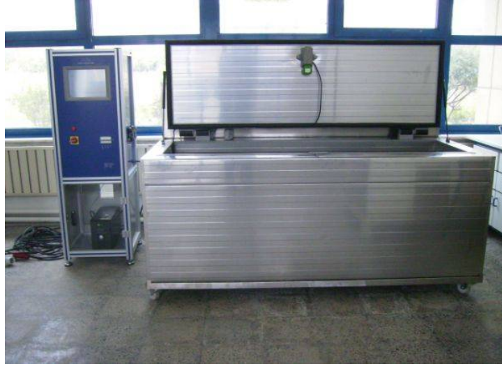
Şekil 3.7. Donma çözülme test cihazı
