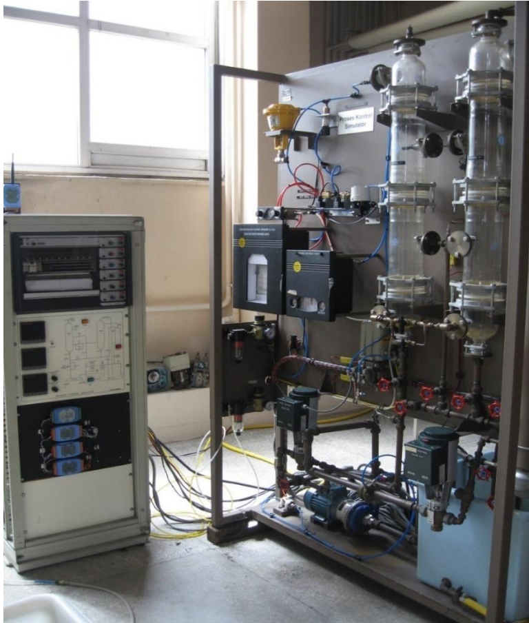
Şekil 2. Kablosuz kontrol amacı ile geliştirilen proses kontrol simülâtörü ( Process control simulator developed with wireless control purpose)
