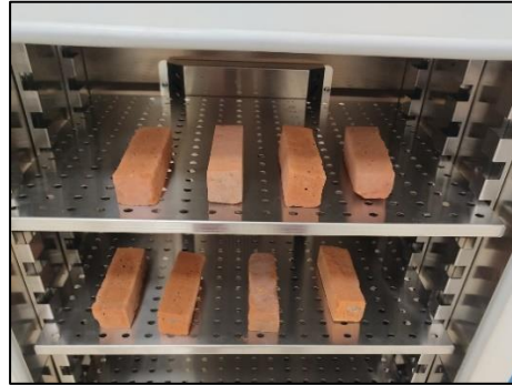
Şekil 3.4. Numunelerin etüvde kurutulması
