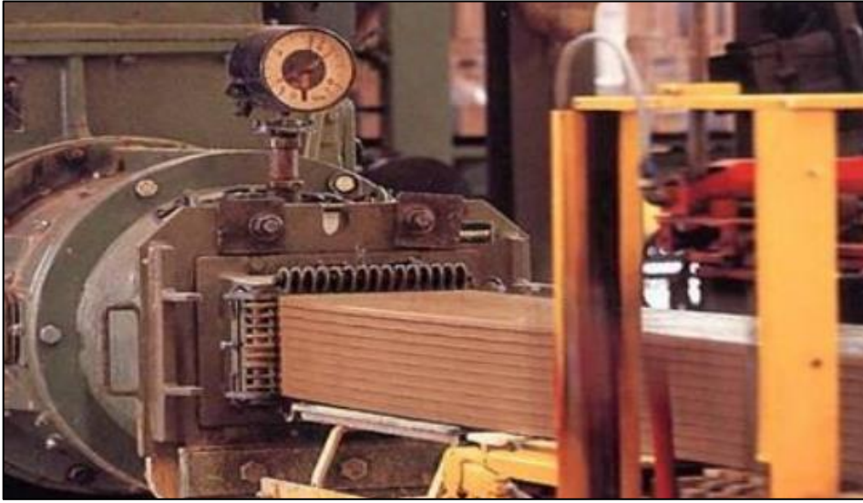
Şekil 2.4. Tuğla kalıp çıkışı (Zal, 2010)
