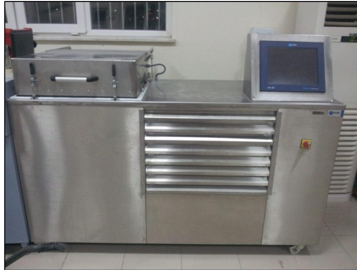
Şekil 3.5. Donma çözülme test kabini
