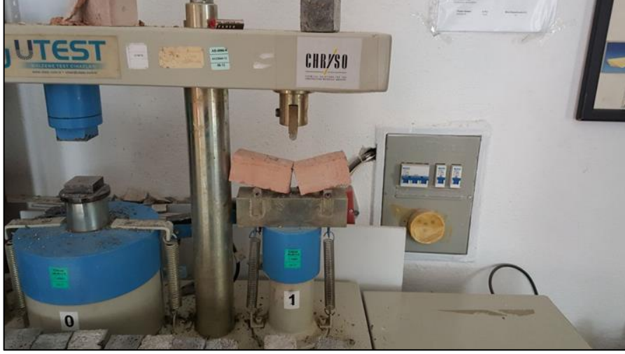
Şekil 3.7. Eğilme de çekme dayanımı
