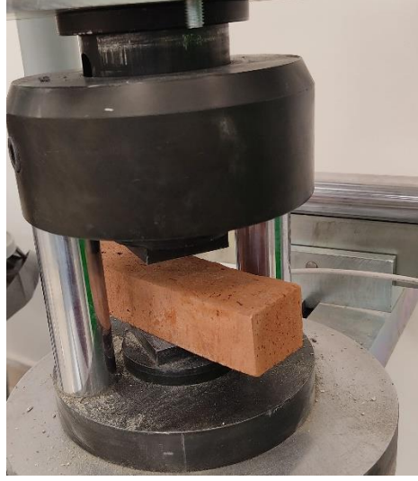
Şekil 3.16. Numunelere uygulanan basınç dayanımı deneyi
