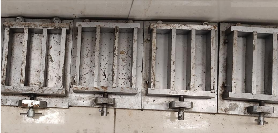
Şekil 3.13. Numune üretiminde kullanılan çelik kalıplar
