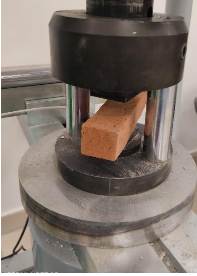
Şekil 3.16. Numunelere uygulanan basınç dayanımı deneyi
