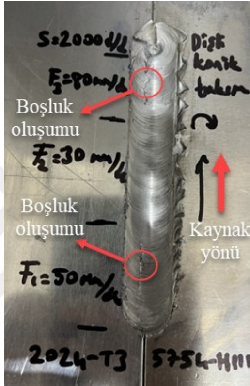
Şekil 4.4. Kaynak hızının yüzey kalitesine etkisi
