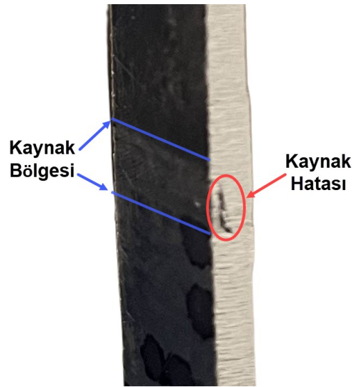
Şekil 4.17. AA2024-T3 alaşımında kaynak hatası
