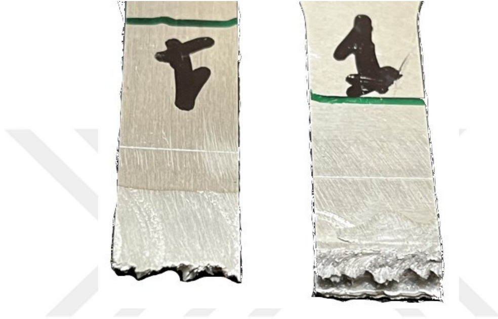
Şekil 4.14. Çekme testi sonrası kopan bir numunenin kopma bölgesi
