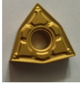
Şekil 3.3. Tornalama operasyonlarında kullanılan elmas (Demirdöğen ve ark., 2022b)
