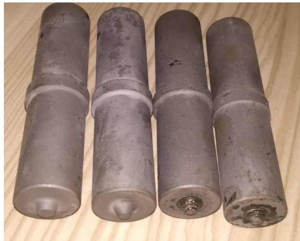
Şekil 3.4. Sertleştirme işlemi sonrası takımların görüntüsü (Demirdöğen ve ark., 2022b)
