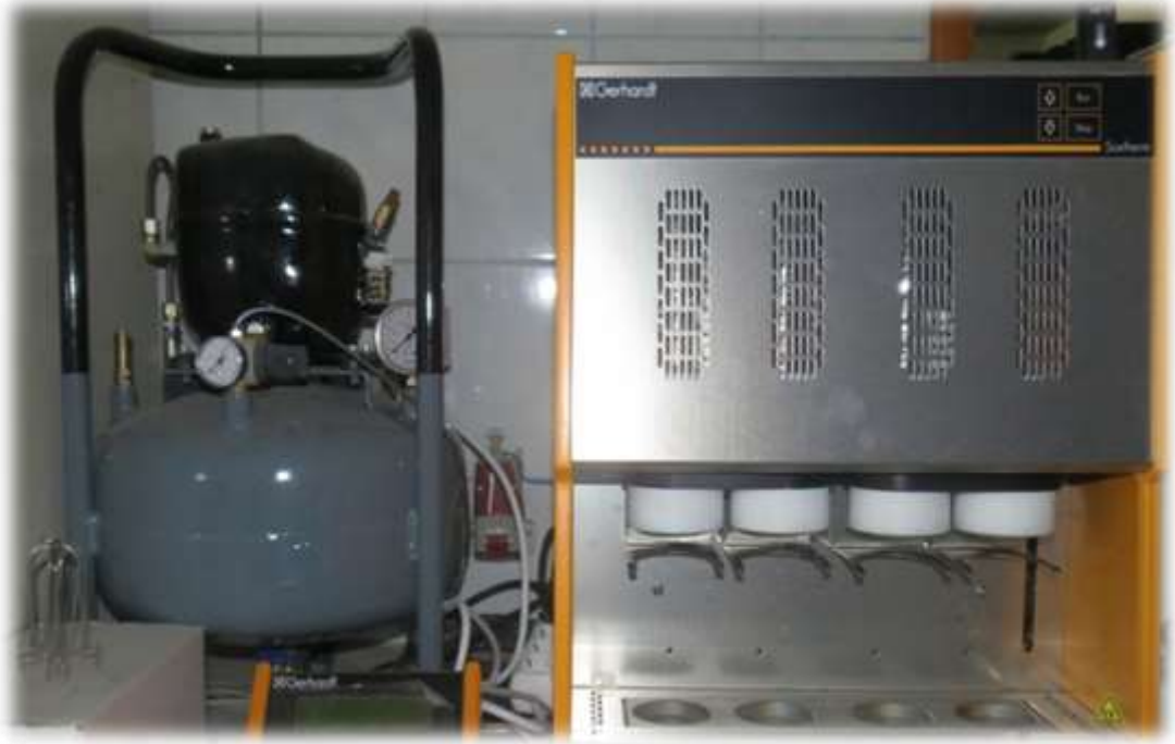
Resim 11. Solvent Ekstraksiyonu yöntemi kullanılarak yağ oranlarının belirlenmesi
