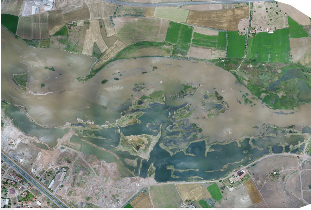
Fotoğraf 4. 12. Kızılırmak'ın küçük ve taşkın yatağı üzerinde Gölşehir yakınlarında uzun süreli kum ocağı işletilmesi neticesinde kıyı alanındaki bozulmalar.
