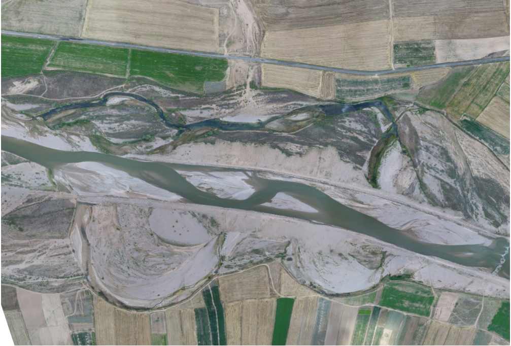
Fotoğraf 4. 11. Kızılırmak ana yatağının Yamalı yakınlarında kanal içine alınması ve akarsuyun doğal yatağında bozulmalar.
