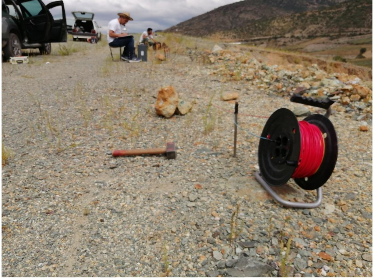
Şekil 3.5 : Çalışma sahasında yapılan DES yöntemine dair bir görüntü.
