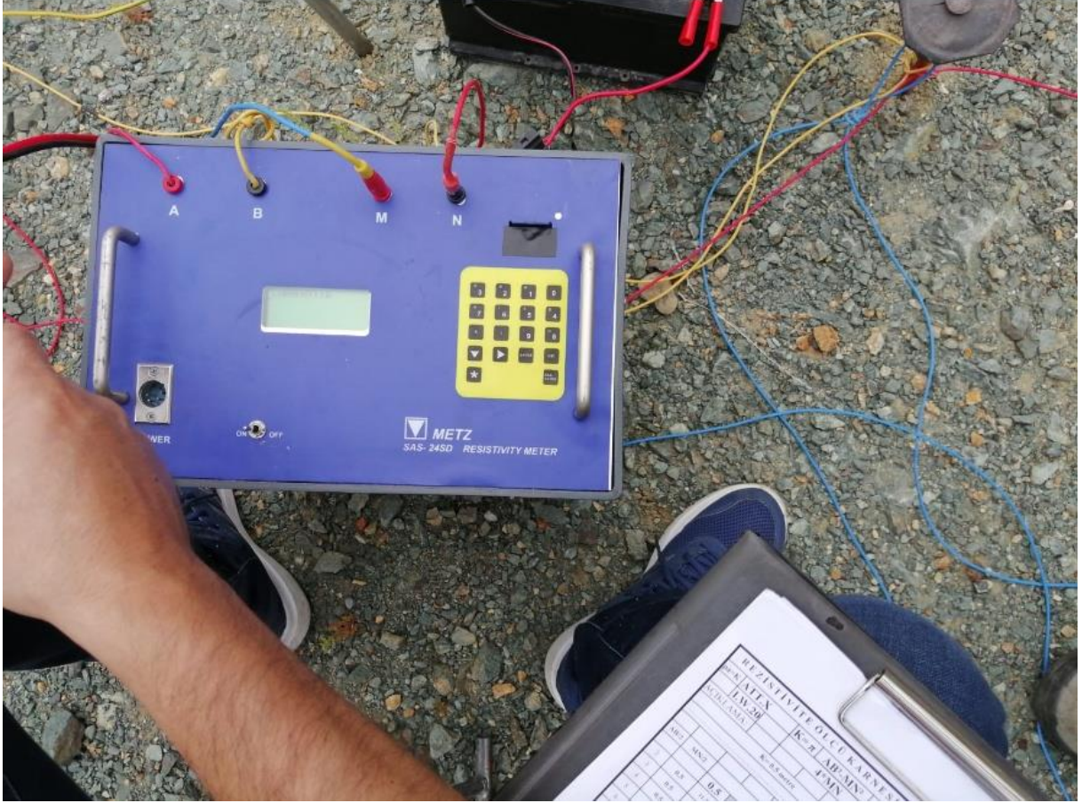
Şekil 4.2 : DES yöntemi için kullanılan ölçüm cihazı.
