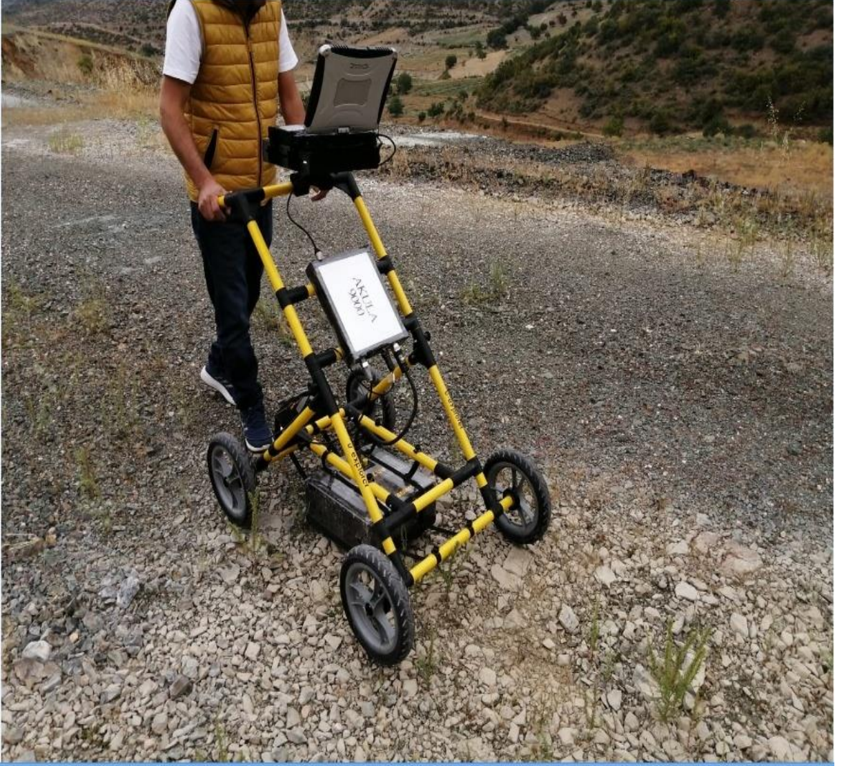
Şekil 4.22 : Çalışma alanında kullanılan yer radarı yöntemi için ölçüm cihazı.
