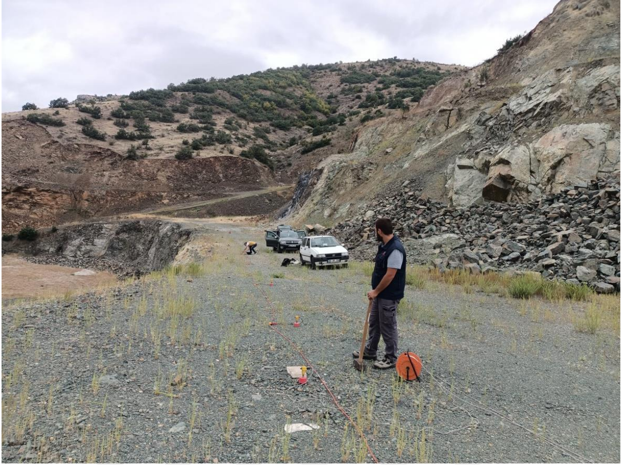
Şekil 3.8 : Çalışma alanında yapılan MASW yöntemi ile ilgili bir görüntü.
