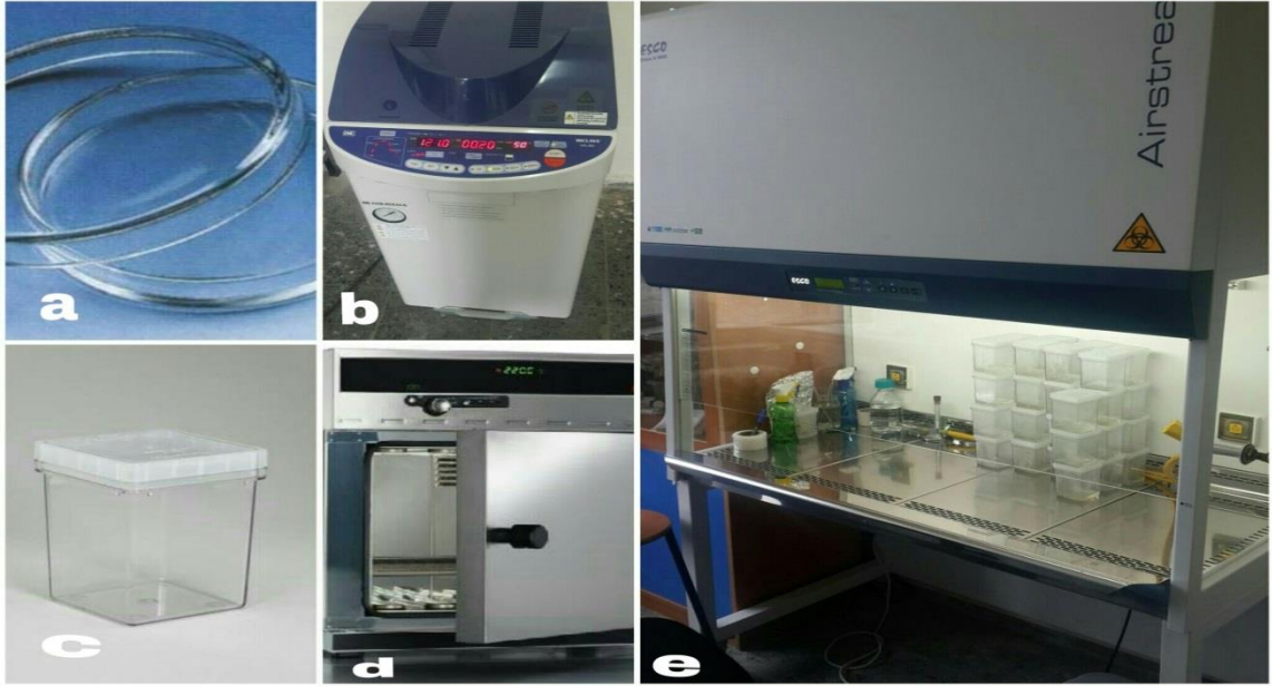
Şekil 3.5. Çalışmada kullanılan cihaz ve malzemelerin görüntüleri (a: cam petri kabı, b: otoklav, c: magenta kabı, d: etüv, e: laminar flow biyogüvenlik kabini)
