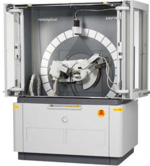
Şekil 3.5. X-ışınları analizlerinde kullanılan Panalytical Empeyrean bilgisayar kontrollü x-ışını difraktometresi
