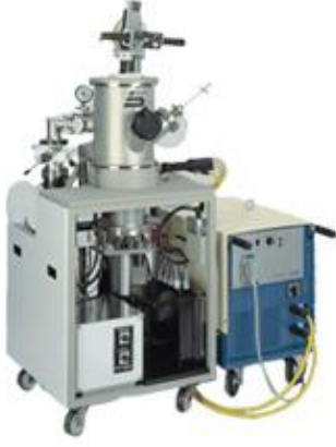
Şekil 3.1. Ark ertitme sistemi ve numune haznesi
