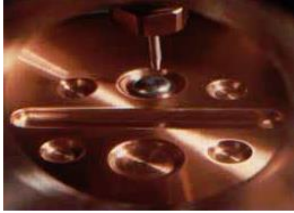
Şekil 3.1. Ark ertitme sistemi ve numune haznesi
