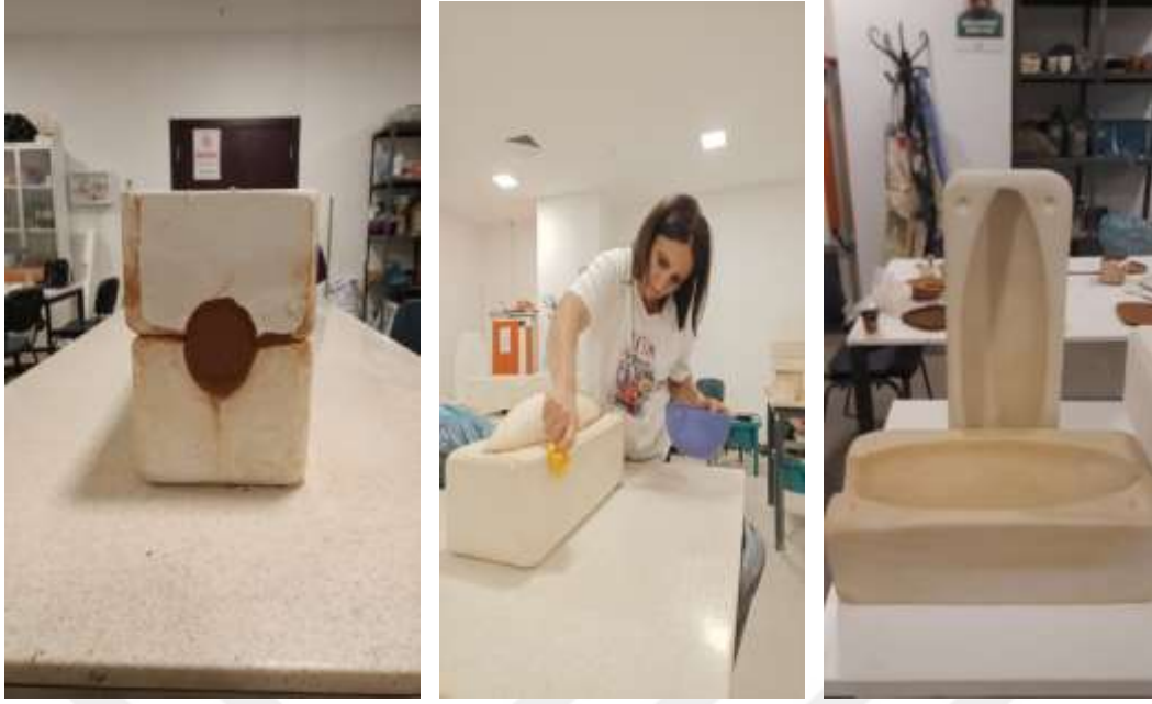
Şekil 3.2.11. Alçı kalıbın temizlenmesi (Macar Köksal, 2023).
