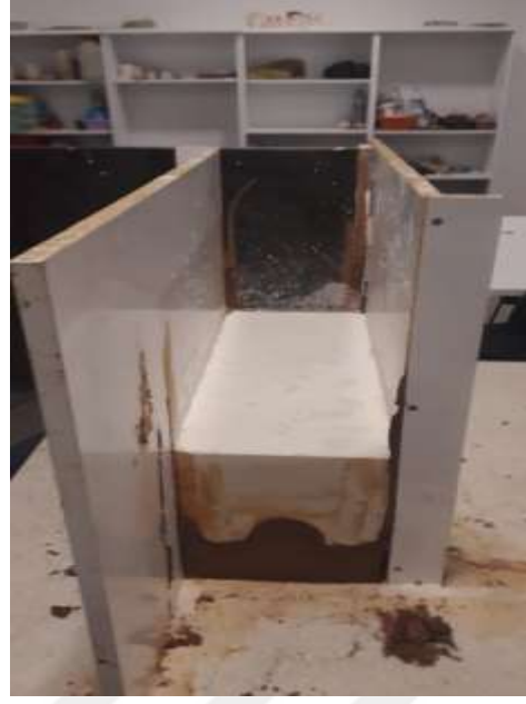
Şekil 3.2.10. Çekirdekten kalıp oluşturma (Macar Köksal, 2023).
