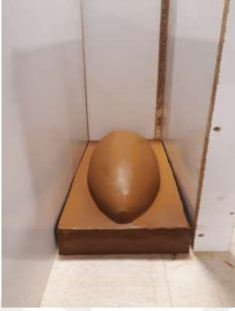
Şekil 3.2.10. Çekirdekten kalıp oluşturma (Macar Köksal, 2023).
