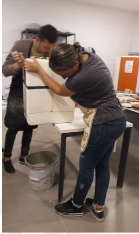
Şekil 3.2.13. Döküm çamurunun alçı kalıplara dökülmesi (Macar Köksal, 2023).
