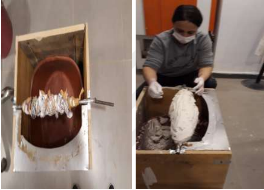
Şekil 3.2.2. a. Mil üzerine gazete ve ip sarımı b. Mil üzerine alçı sıvama (Macar Köksal, 2023).
