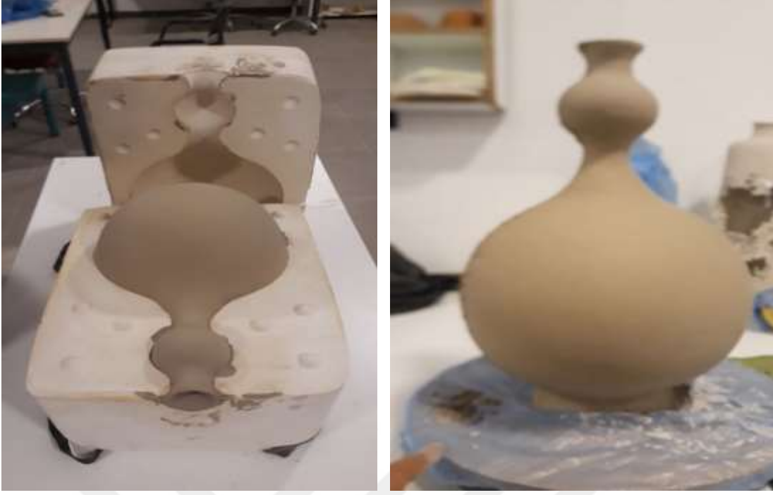
Şekil. 3.2.14. Seramik formun kalıptan çıkarılması (Macar Köksal, 2023).
