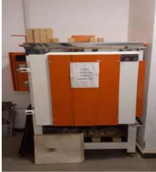
Şekil 3.2.18. Seramik atölyesinde kullanılan elektrikli fırın (Macar Köksal, 2023).
