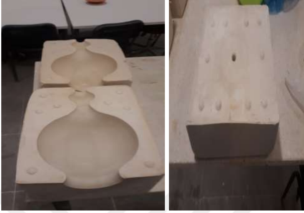
Şekil 3.2.9. Üç kalıptan oluşan vazo kalıbı (Macar Köksal, 2023).
