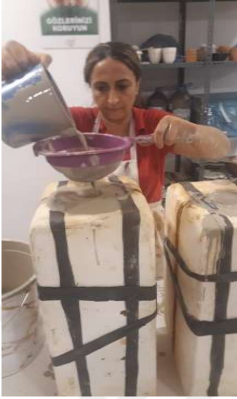
Şekil 3.2.13. Döküm çamurunun alçı kalıplara dökülmesi (Macar Köksal, 2023).
