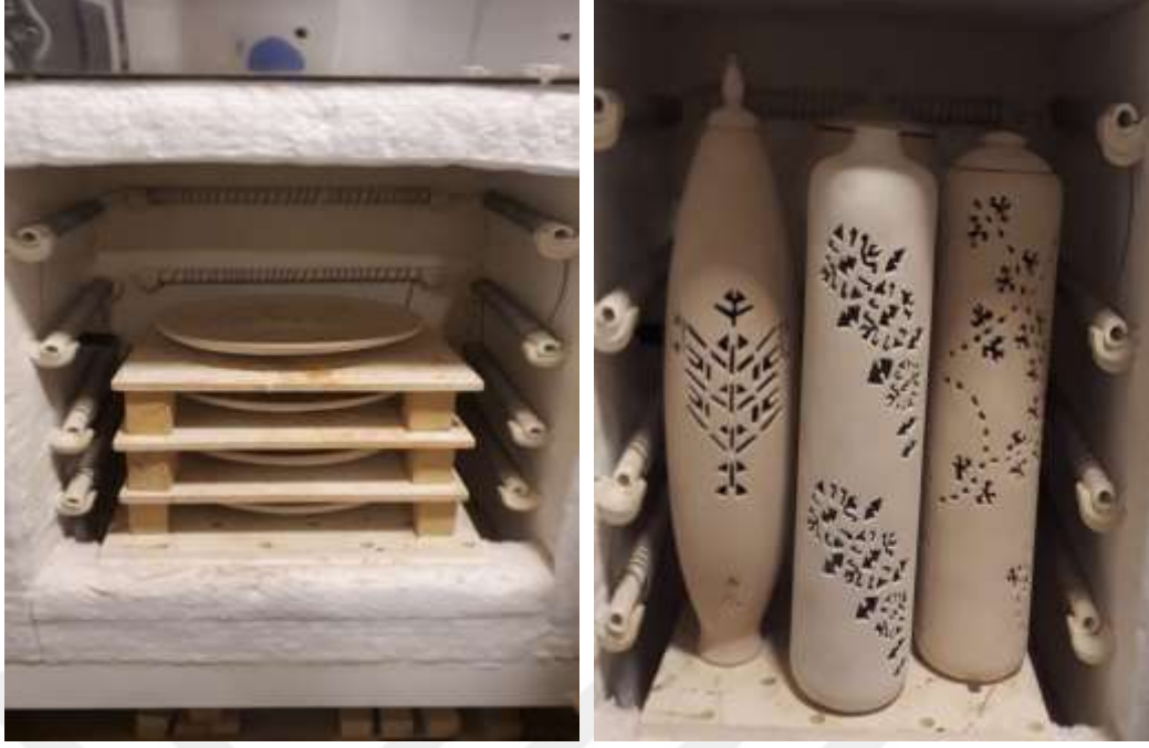
Şekil 3.2.19. Elektrikli fırın (Macar Köksal, 2023).
