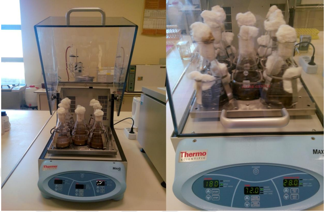
Resim 3.4. alkalayıcı inkübatör (180 rpm`de 28 °C`de 72 saat inkübasyon)
