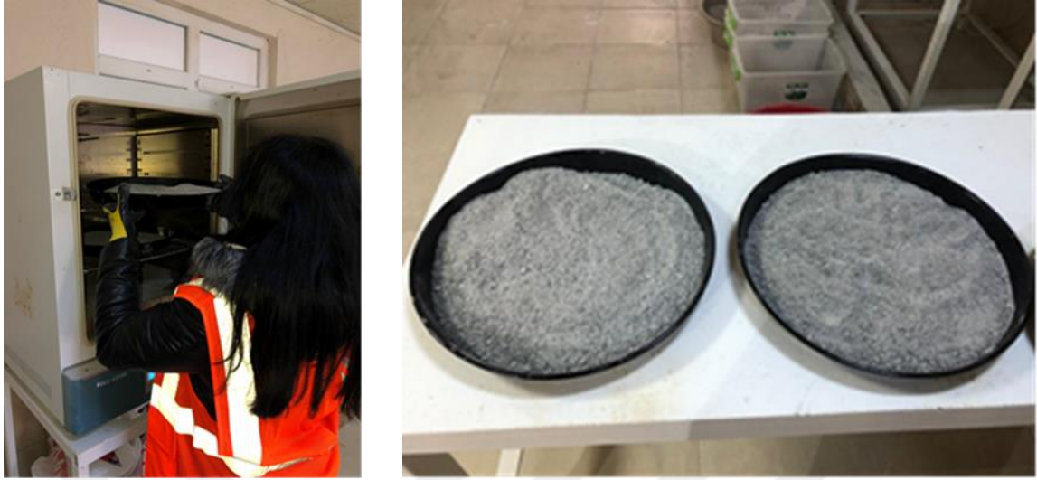
Şekil 3.5: a) Etüv b) Nemi Giderilmiş Malzeme.
