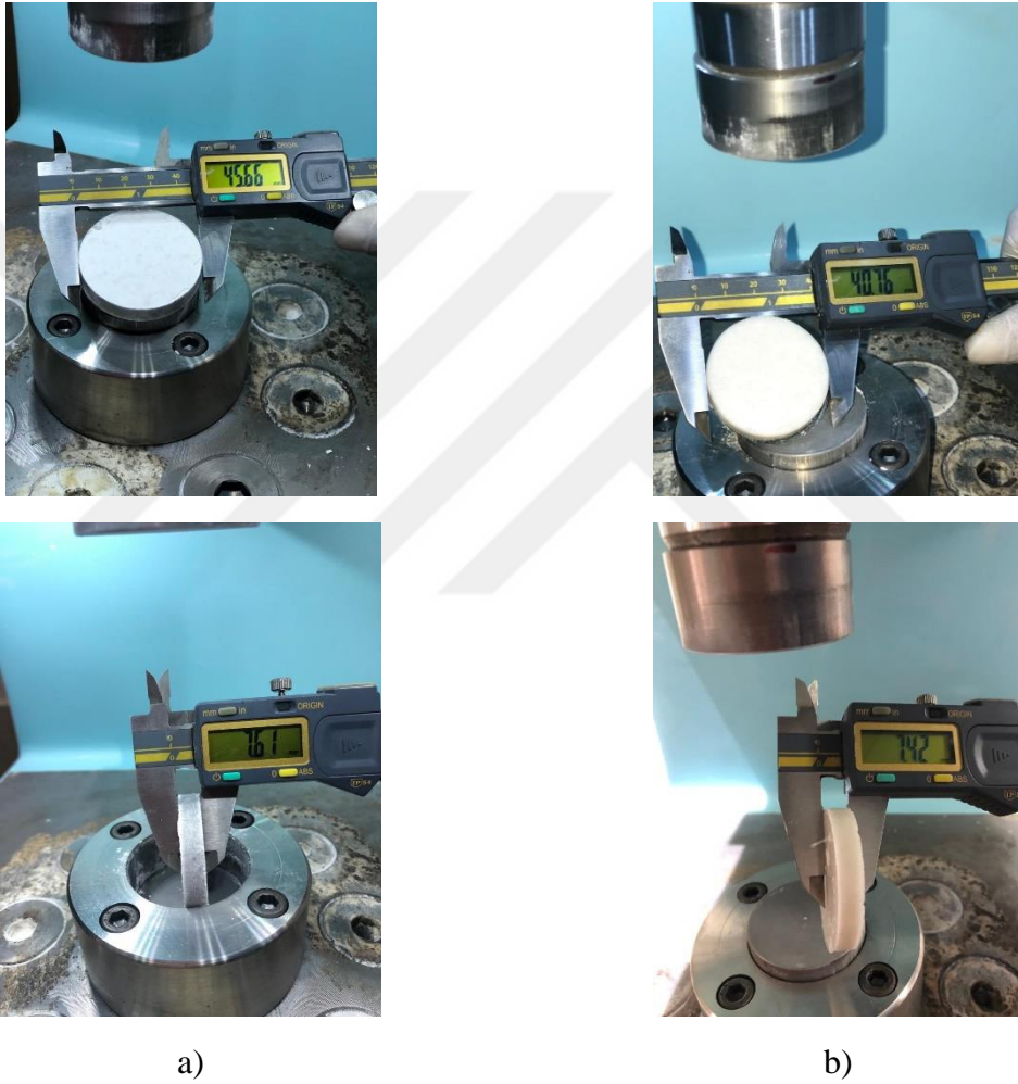
Şekil 3.17: a) Pişme Öncesi Kumpas Ölçümü b) Pişme Sonrası Kumpas Ölçümü.
