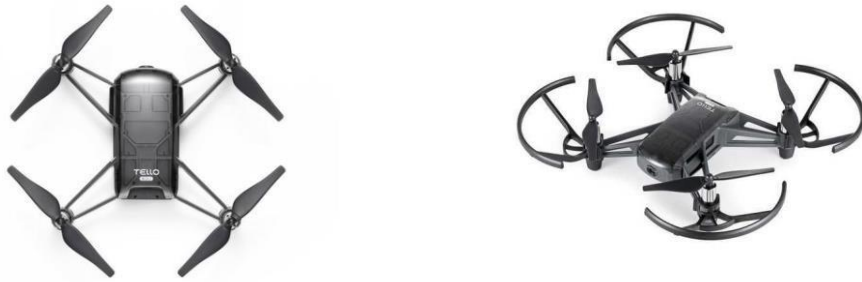
Şekil 4.1. DJI Tello EDU iç ve dış ortam gövdeleri [79].
