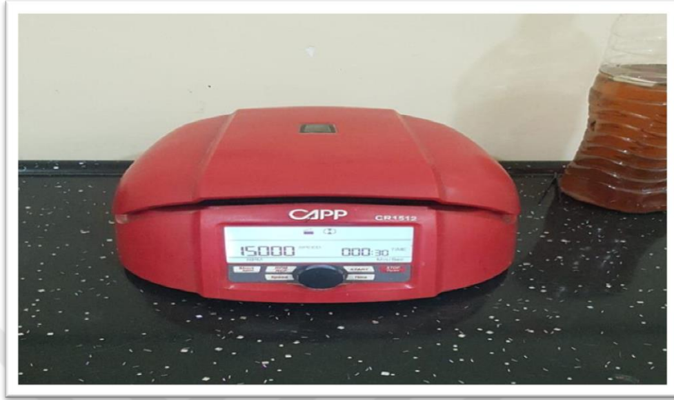
Şekil 3-3. Exispin girdap santrifüjü: Cihaz, DNA, RNA ve protein örneklerini ayırmak ve saflaştırmak için kullanılır.
