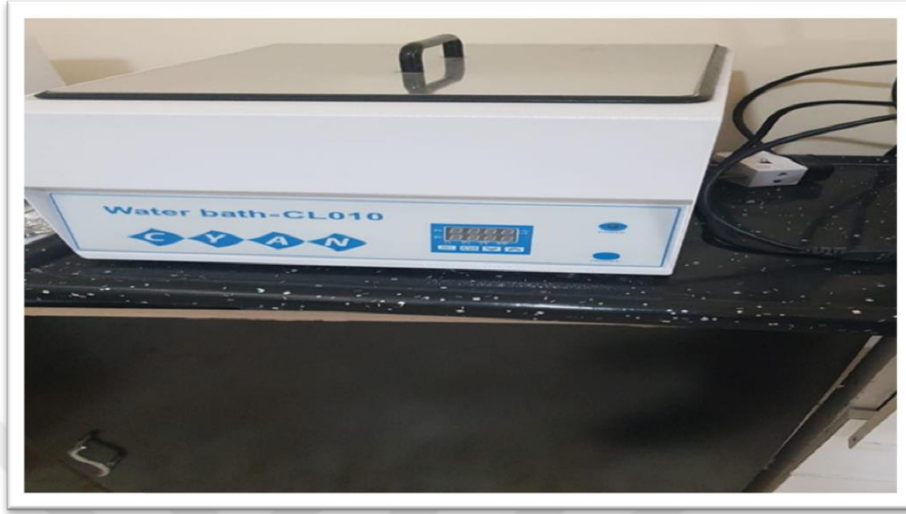
Şekil 3.1. Su Banyosu: Numuneleri belirli bir süre boyunca sabit sıcaklıkta suda inkübe etmek için kullanılır.
