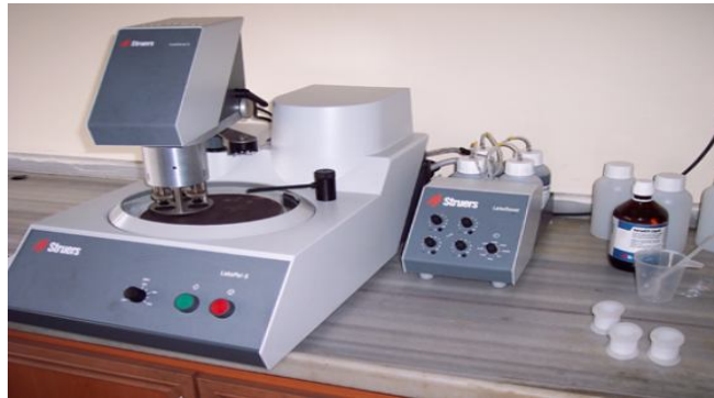
Şekil 4.1 Deney parçası analiz öncesi zımparalama işlemi
