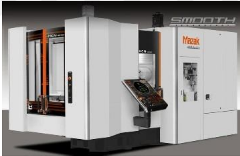
Şekil 4.8 4 eksenli Mazak HCN-4000 yatay işleme merkezi
