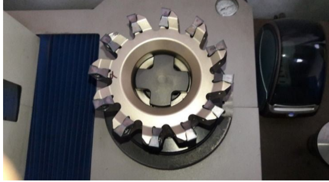
Şekil 4.9 12 ağız geometrisine sahip tarama (freze) takımı
