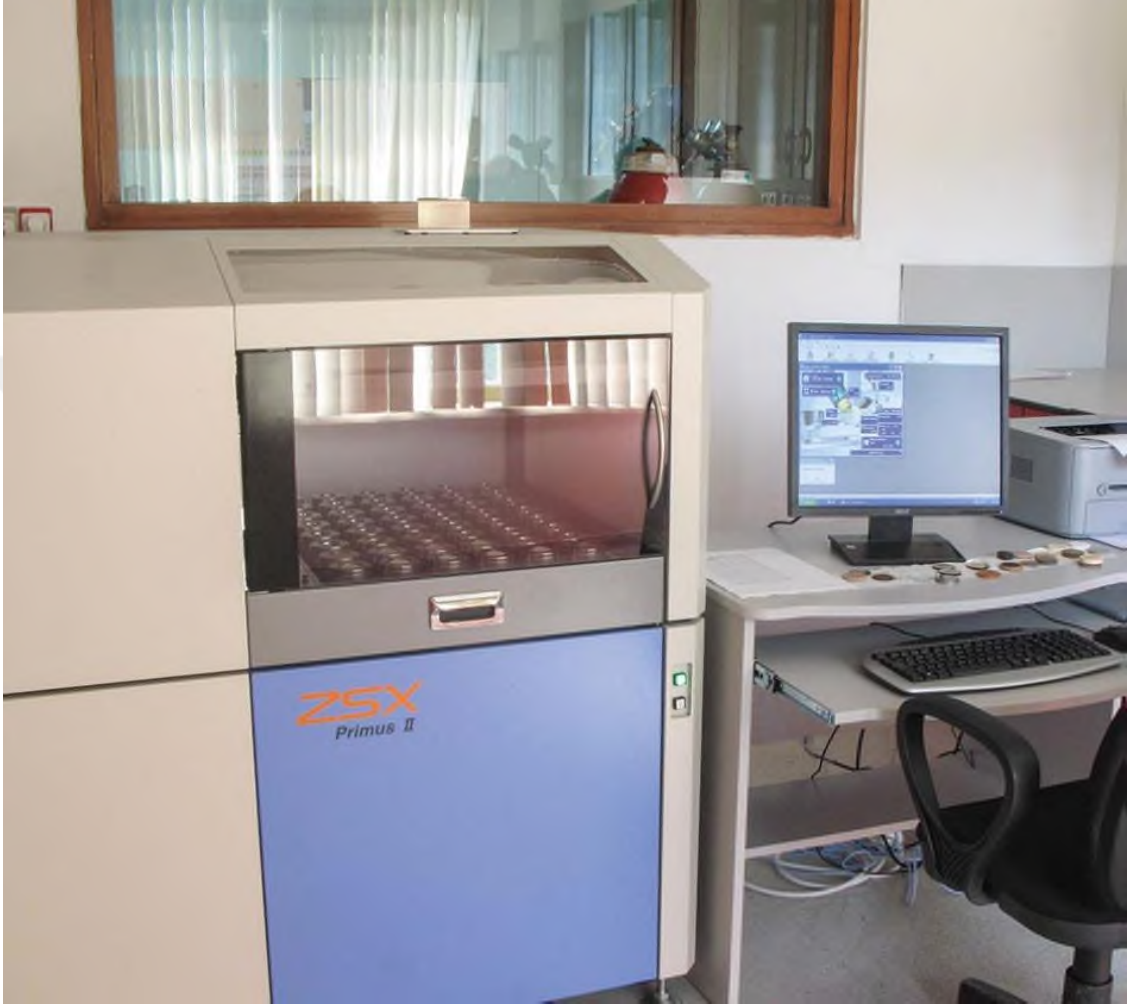
Şekil 3.2. Dalga boyu dağılımlı X-ışını floresans spektrometresi (WDXRF). (Marka: Rigaku. Model: ZSX Primus II) ( http://www.mersin.edu.tr/akademik/ileri-teknoloji-egitim-arastirma-ve-uygu-lama-merkezi )
