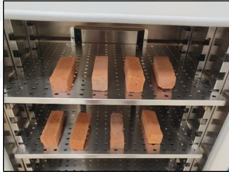
Şekil 3.4. Numunelerin etüvde kurutulması
