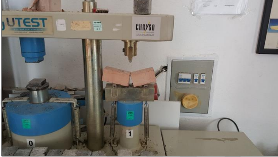
Şekil 3.7. Eğilme de çekme dayanımı
