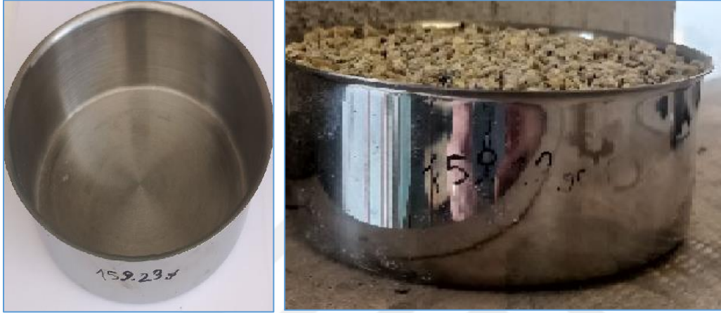
Şekil 3.3. Pelet hacim yoğunluğu testinde kullanılan kap
