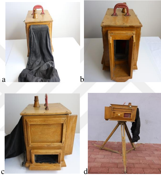
Şekil 4.85. Fotoğraf makinası: a-çekim alanı,b-yan görünüm,c-karanlık bölümü ,d-tripot üstünde görünüm,
