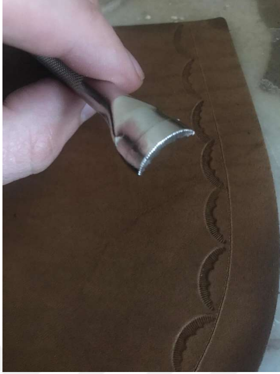
Şekil 31. Bir kraft modeli ve kraft yapılmakta olan ıslatılmış deri (Orkun, 2020).
