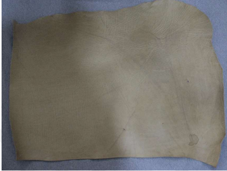
Şekil 7. 2.5 mm kalınlığında yarı mamul olarak alınmış ve natürel renk tasarıma uygun olarak seçilmiş kösele deri (Orkun, 2020).
