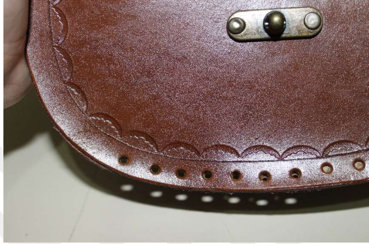
Şekil 41. Çarklı zımba ile delinmekte olan deri çanta (Orkun, 2020).
