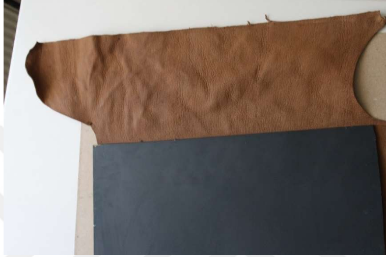
Şekil 50. Kenar pay ve boşluklarını ayarlama işlemi (Orkun, 2020).
