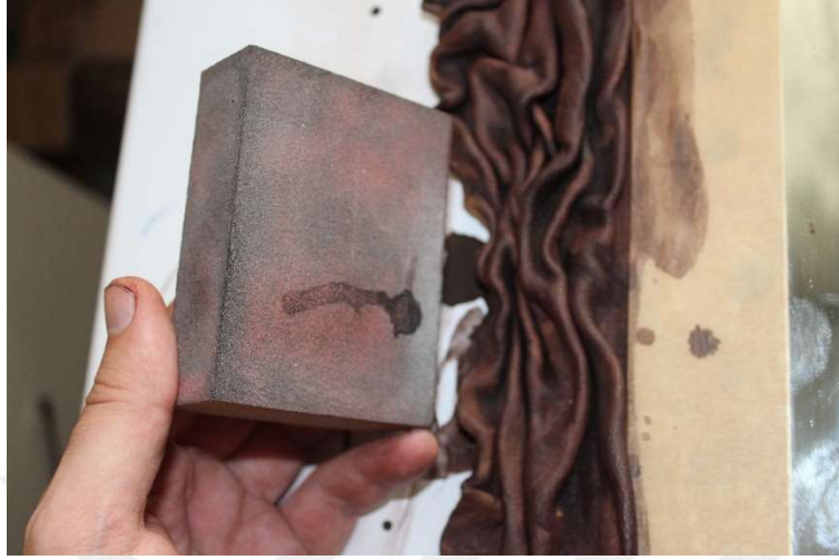
Şekil 56. Zımparalama işlemi, kare zımpara (Orkun, 2020).
