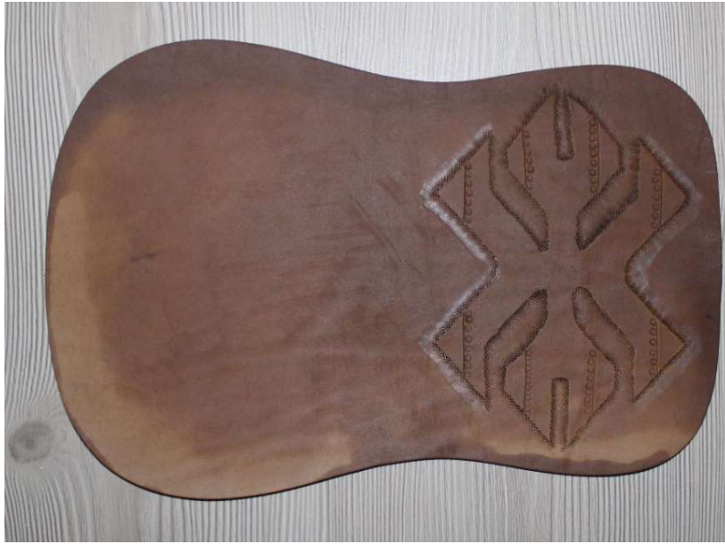
Şekil 30. Islatılmış ve kraft işlemi başlatılmış deri çanta kapağı (Orkun, 2020).
