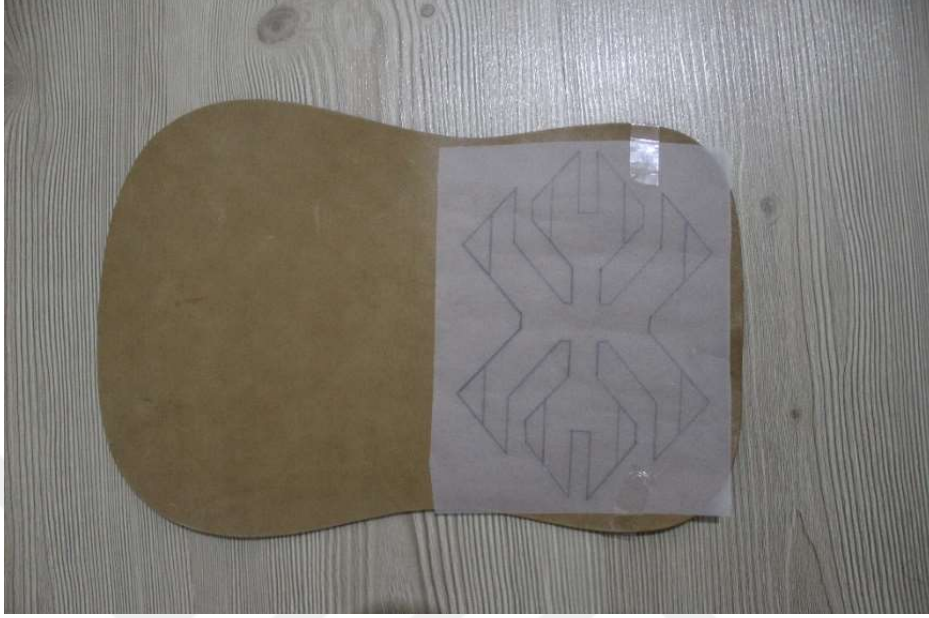
Şekil 29. Aydinger kağıdından, deriye çizimin aktarılması (Orkun, 2020).
