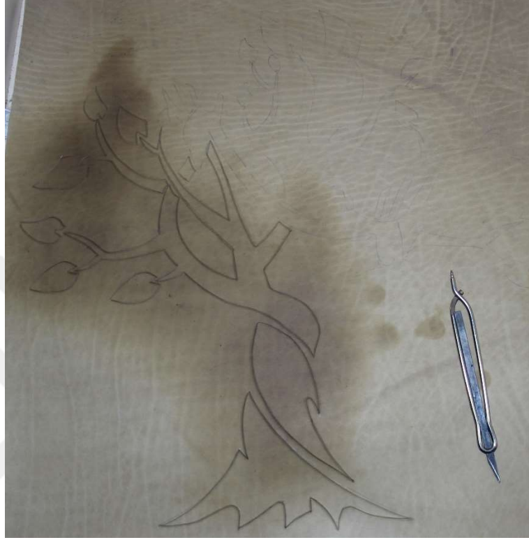
Şekil 8. Islatılmış deride deri kesim bıçağı ile desenin yüzeye çizilmesi (Orkun, 2020).
