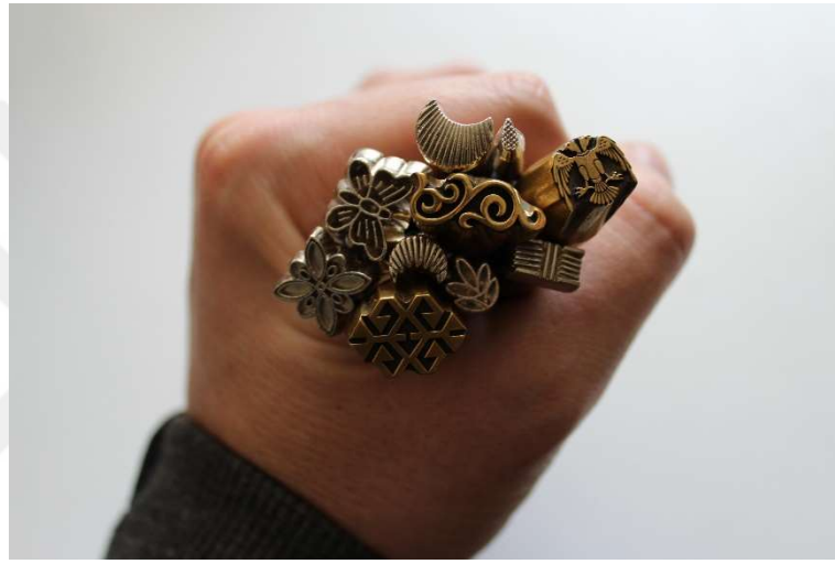
Şekil 5. Amblem basma aracı, deri sektöründe bilinen adı ile kraft (Orkun,2020).
