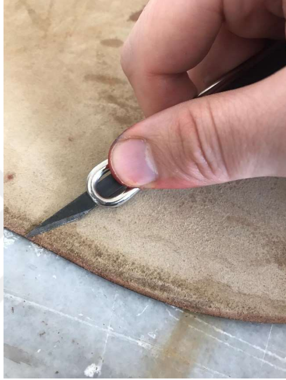
Şekil 38. Deri çanta birleştirme noktaları tıraşlama işlemi (Orkun, 2020).
