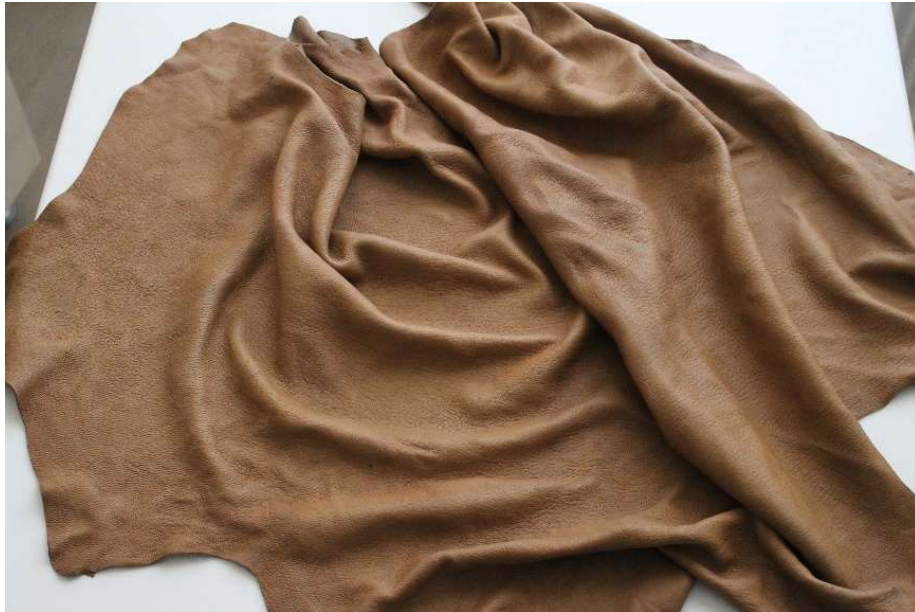
Şekil 49. 48 saat su içerisinde beklemiş masklık deri. (Orkun, 2020).
