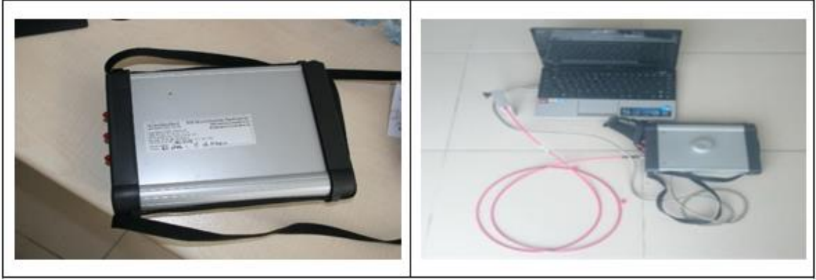
Şekil 3. 4. Kanopi Seviyesi Spektral Yansıma Ölçümlerinin Alınması İçin Kullanılan El Spektroradyometresi (Orijinal).
