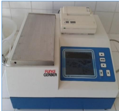
Şekil 3.1. Süt analiz cihazı
