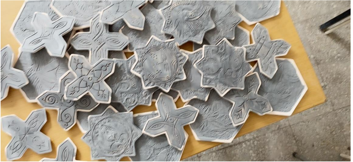
Şekil 3.1.8. Sür-sil işlemi bitirilmiş mamul (Denizli Tüzün, 2022).
