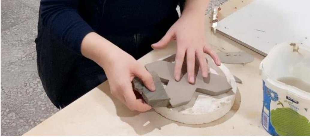
Şekil 3.1.4. Kalıptan çıkarılan seramik formların rötuşlanması (Denizli Tüzün, 2022).
