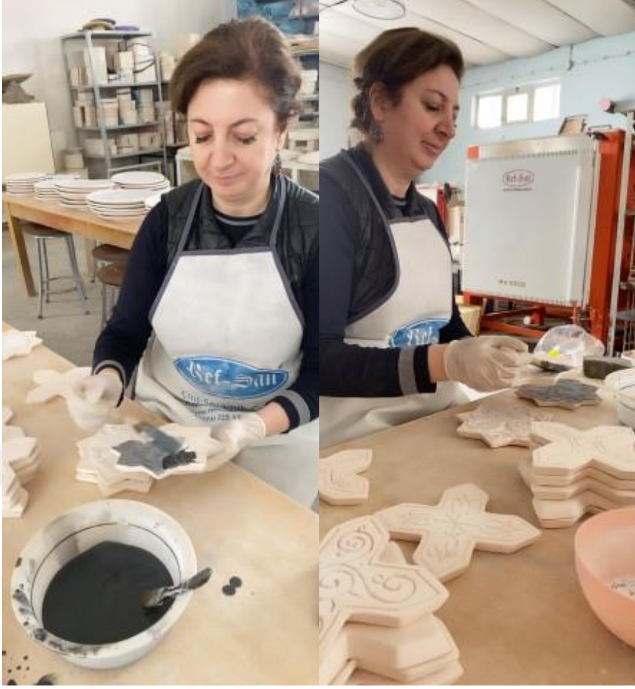
Şekil 3.1.7. Sür-sil işlemi (Denizli Tüzün, 2022).
