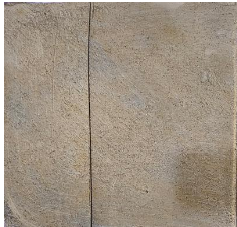
Şekil 3.2.10.2. Yoğurulan çamurun plaka haline getirilmesi (Denizli Tüzün, 2022).
