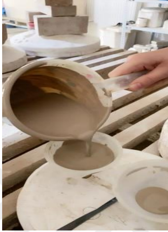
Şekil 3.1.2. Çamurun alçı kalıplara dökülmesi (Denizli Tüzün, 2022).
