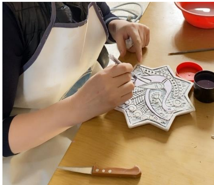
Şekil 3.1.10. Renkli sırların uygulanması (Denizli Tüzün, 2022).
