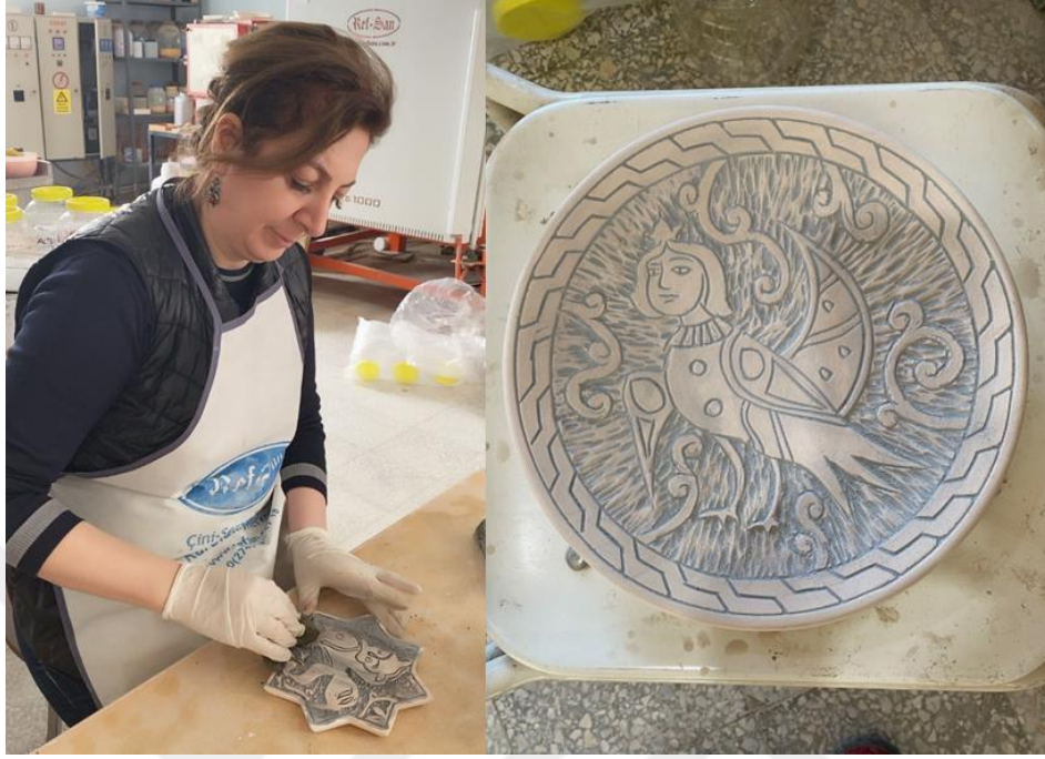
Şekil 3.1.9. Siyah metal oksit emisyon fazlasının silinmesi ve silinmiş ürün (Denizli Tüzün, 2022).
