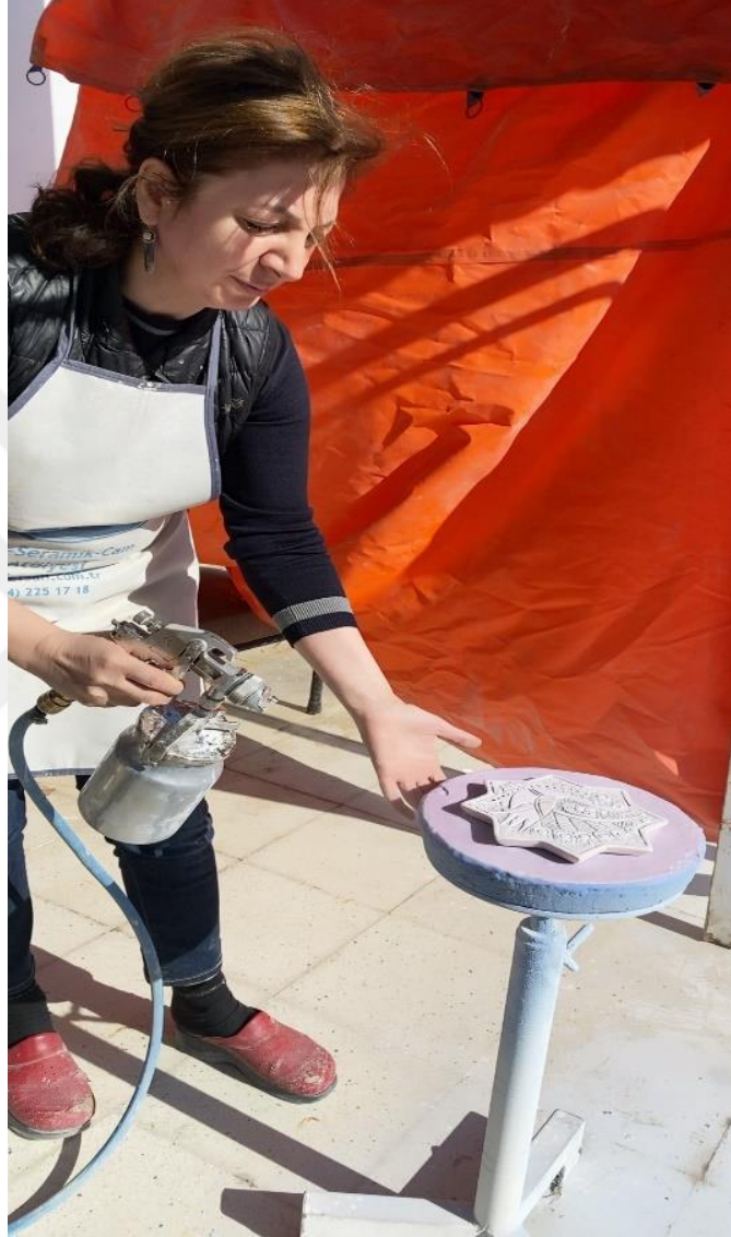
Şekil 3.1.11. Pistole ile şeffaf sır uygulanması (Denizli Tüzün, 2022).
