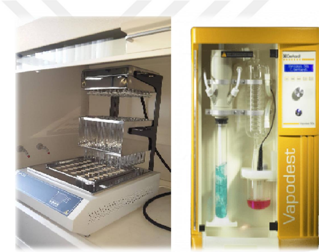
Şekil 3.8. Numune yakma ünitesi ve distilasyon cihazı
