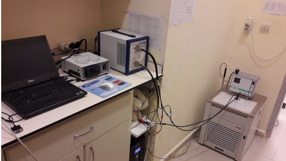
Şekil 3.3. Empedans ölçüm düzeneği.
