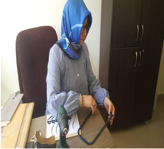
Resim 2.29. Kıl testerenin yerleştirilmesi (Ayşe BAŞARMAK Arşivi, Kırşehir, 2021)
