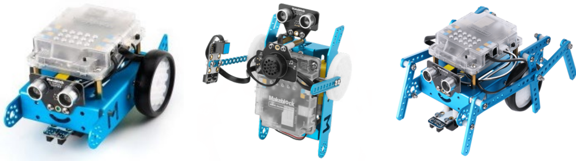
Şekil 2.6 mBot ve Eklentiler ile Yapılmış Robot Örnekleri
