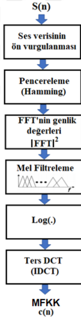
Şekil 2.5. MFCC katsayılarının elde edilme aşamaları
