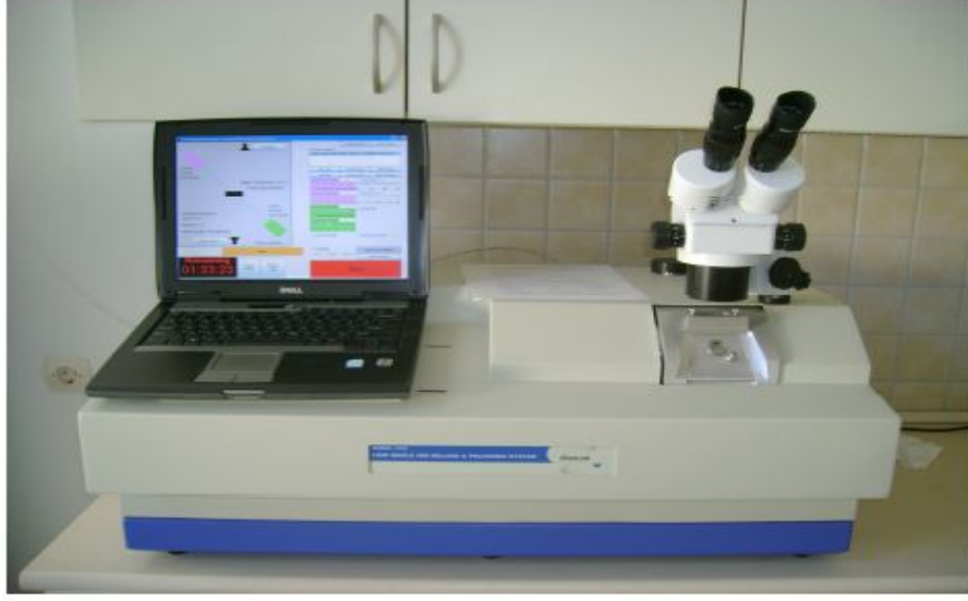
Şekil 2.14. TEM numunelerinin hazırlanmasında kullanılan Fischione1010 model iyon değirmeninin resmi ( Kırıkkale Üniversitesi, Araştırma merkezi )
