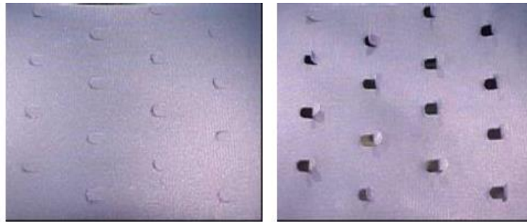
Şekil 2.28. Çam kozalağından esinlenilerek yapılmış kompozit tekstil yüzeyi (Kapsali, 2009: 60).
